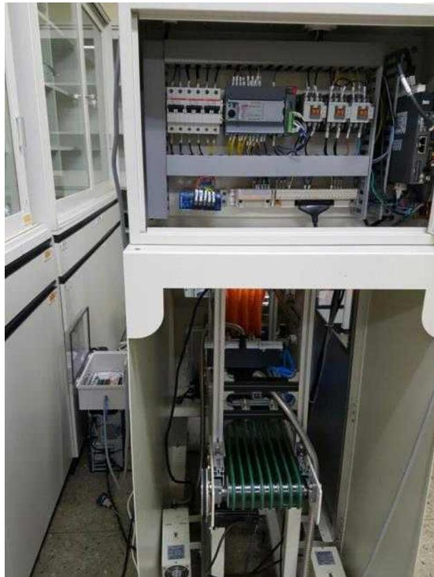
그림 2-57. 제어판에 설치된 임베디드 아두이노의 실제 모습
