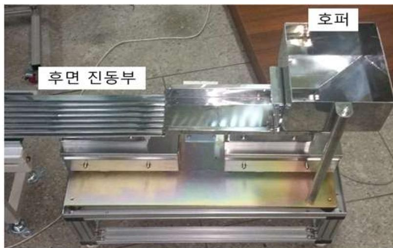
그림 5-8. 호퍼 및 후면 진동부 사진
