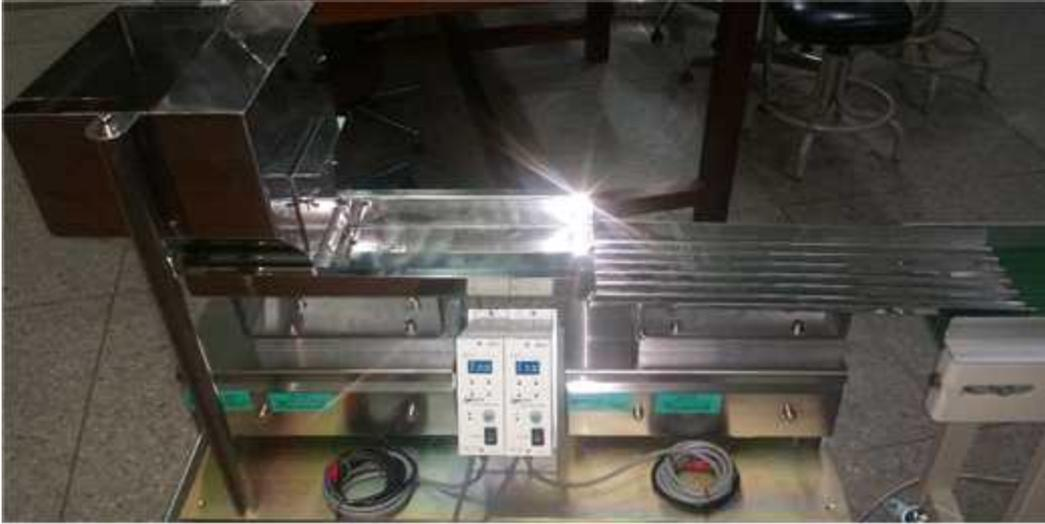
그림 5-6. 후면 이송부 및 컨트롤러 사진
