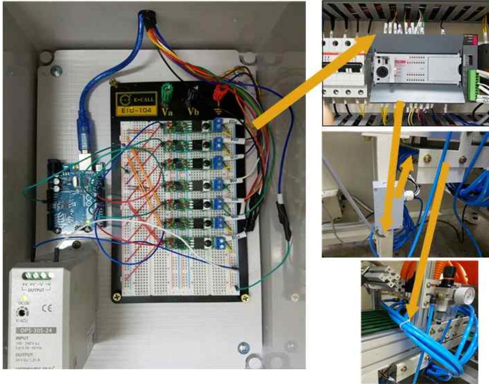
그림 5-27. 아두이노를 이용한 배출부의 실제 신호전달 순서
