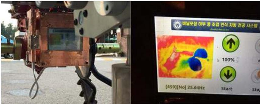
Fig. 239. (좌) 구리 커버 하우징 장착, (우) 비닐포장 하부 작물 인식 결과
