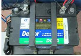
천공기 작동을 위해 설치된 DC 12V용 충전식 심방전 배터리(관리기의 제너레이터를 이용 충전)
