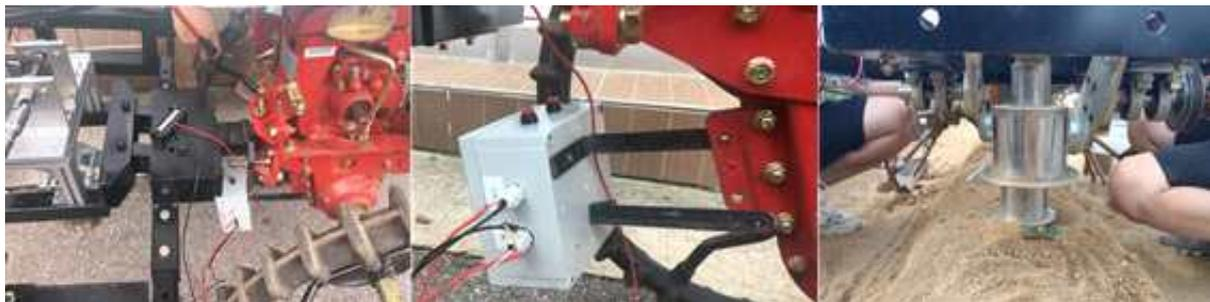
Fig. 234. (좌) 작업기에 천공기 설치, (중) 하우징 설치, (우) 천공 테스트 진행
