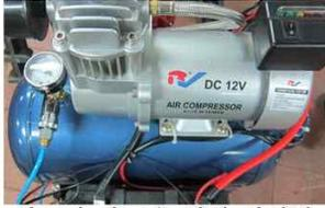
천공기 작동을 위해 설치된 DC 12V용 에어 콤프레샤 (천공기에 장착된 배터리를 이용하여 동작)
