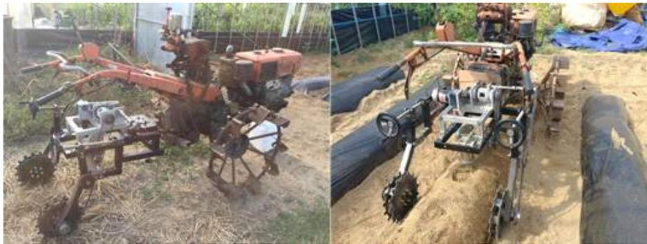
Fig. 241. (좌) 주행 본체 교체 후 통합 모듈 설치, (우) 테스트 베드 실제 천공 모습
