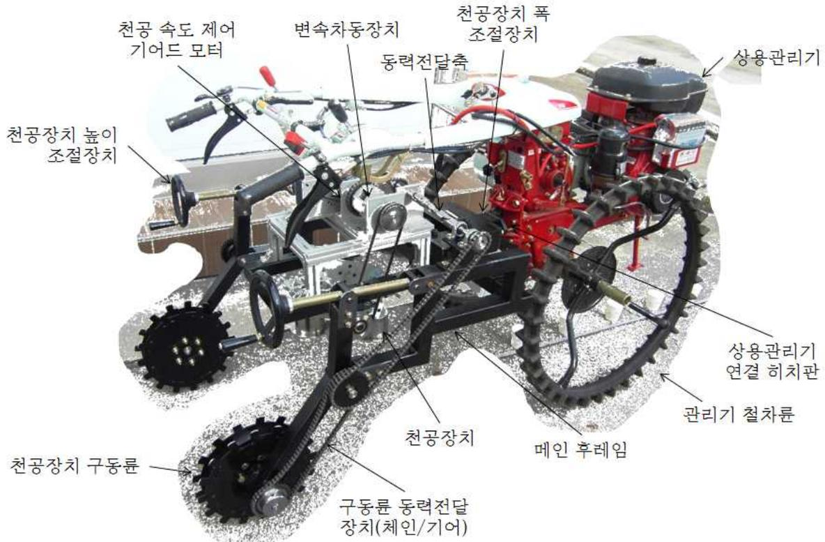
Fig. 216. 3<sup>rd</sup> year automatic punching machine prototype (범용으로 제작)
