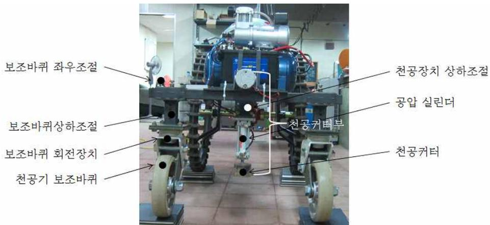
Fig. 86. 제작된 1차년도 요인시험장치 정면 주요부 구성
