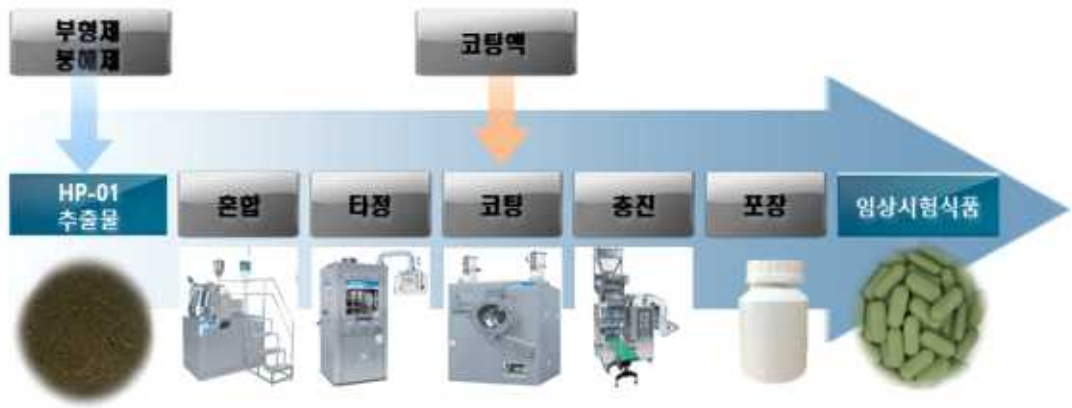
[그림 223] 인체적용시험용 시험약 제조공정도
