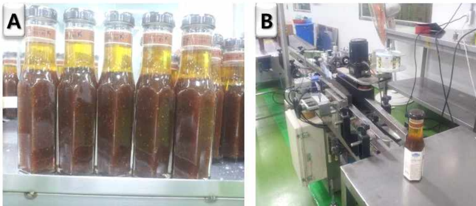
Fig. 20. 병 충전 후 캡핑 공정까지 완료된 제품(A), 라벨포장까지 완료된 최종 제품(B)
