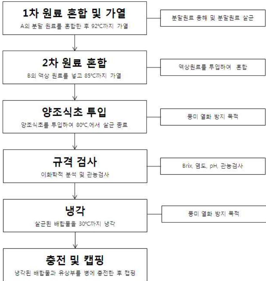
Fig. 18. 현미발효물 적용 오리엔탈 드레싱 Scale-up 제품의 제조과정
