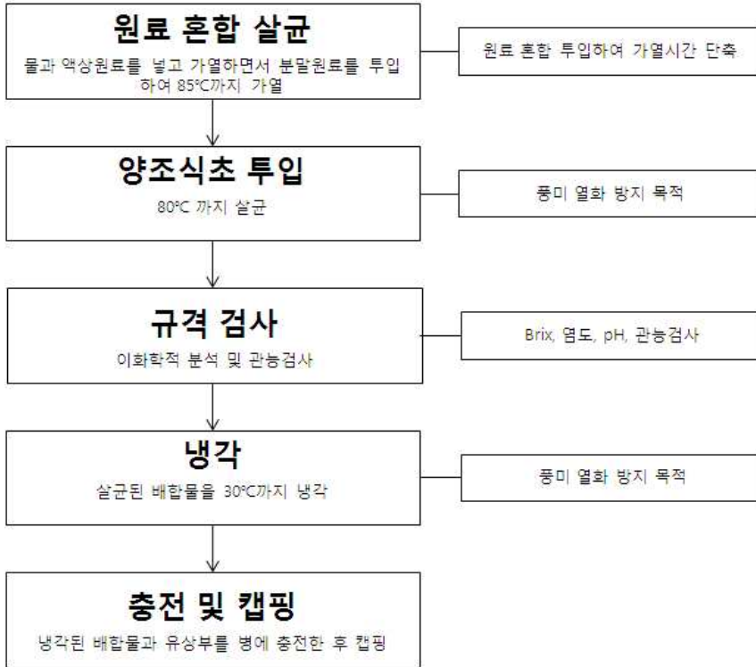
Fig. 19. 현미발효물 적용 오리엔탈 드레싱 700kg 본생산시 제조 공정
