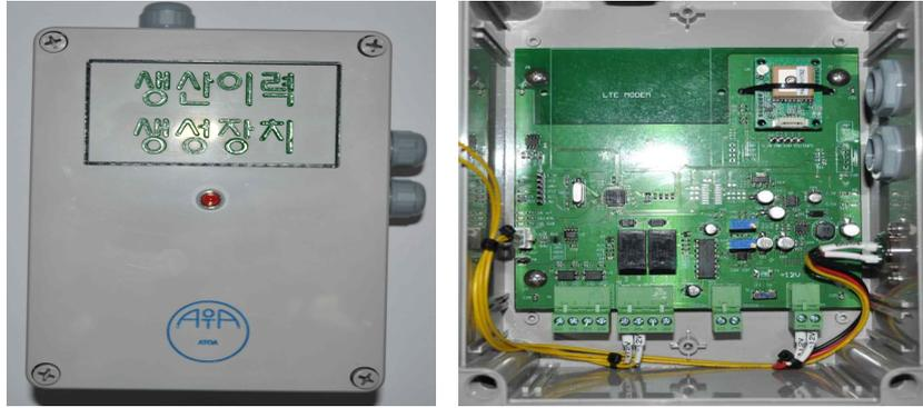
그림 33. 생산이력 수집 및 송신 시스템 슬레이브 컨트롤러
