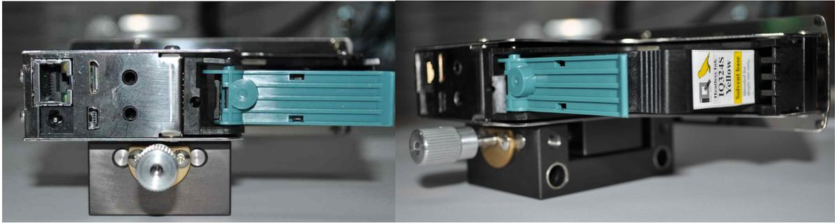
그림 61. 생산 이력 프린팅 시스템 프린트 모듈
