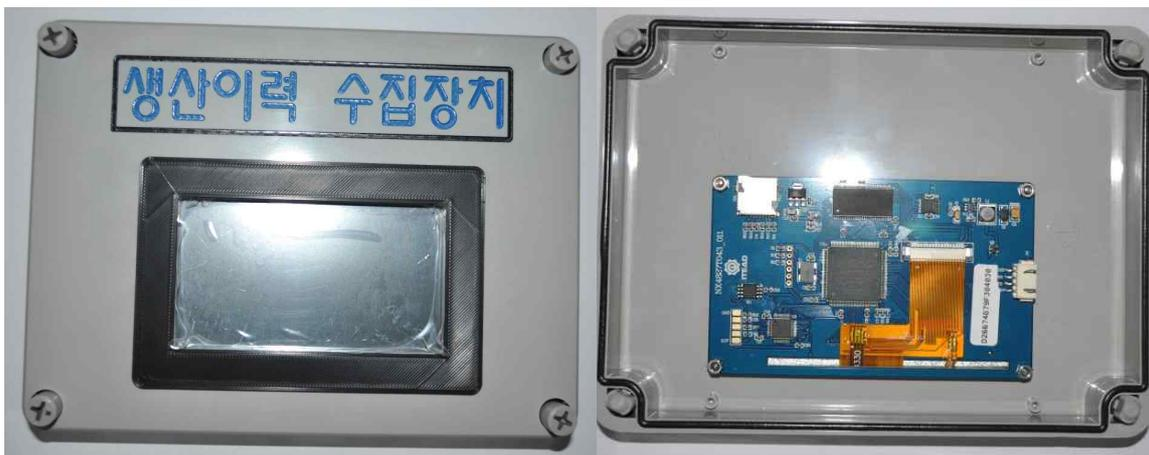
그림 24. 생산이력 수집 및 송신시스템 Touch Screen Display
