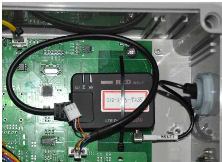
그림 27. 생산이력 수집 및 송신시스템 LTE Modem
