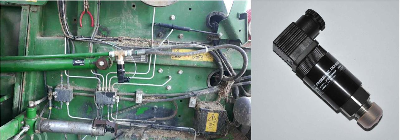
그림 39. 생산이력 장치 베일러에 설치된 압력 센서
