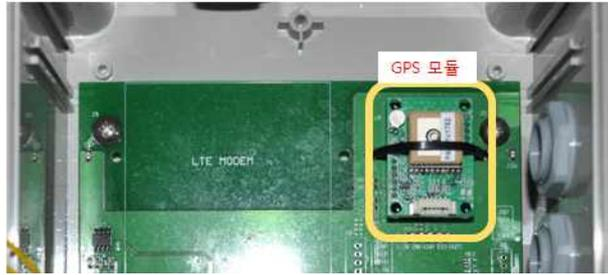
그림 41. 생산이력 수집 및 송신시스템 Slave GPS Module
