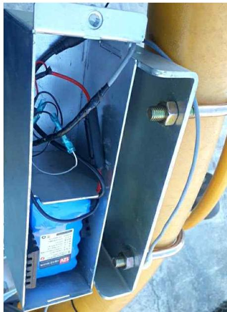
그림 54. 생산 이력 프린팅 시스템 테스트 설치 배터리
