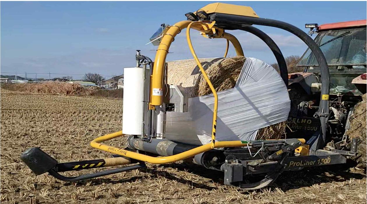
그림 63. 프린터가 Wrapper에 부착되어 프린팅 하는 모습
