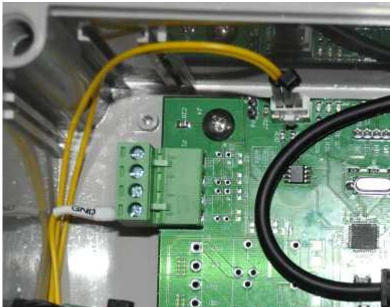
그림 43. 생산이력 수집 및 송신시스템 Slave RS485 Transceiver
