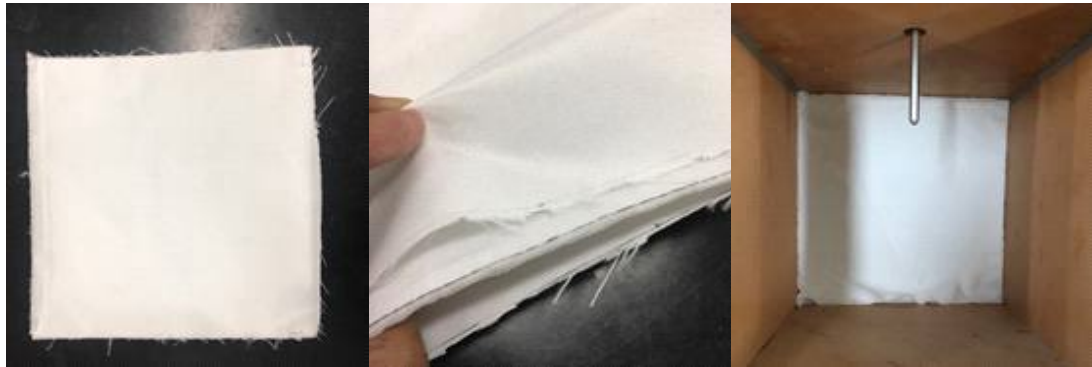
그림. 16 에어로젤과 마트를 사용한 보온커튼 보온성 시험
