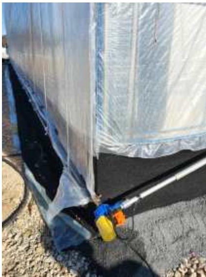
그림. 32 실험용 하우스 외부 권치 장치
