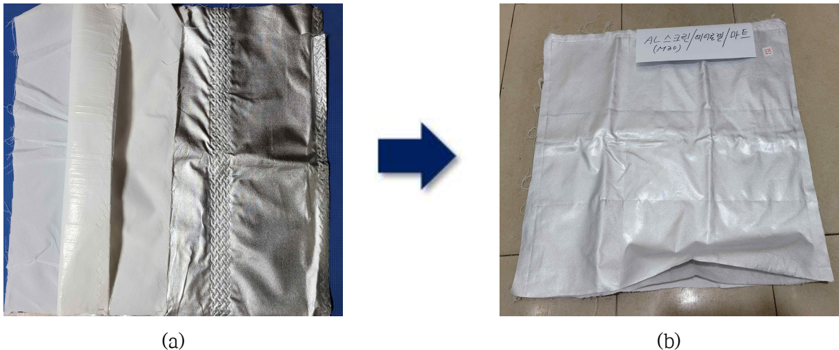
그림. 73 (a) 필름형 에어로겔시트와 (b) 부직포(원단)형 에어로겔시트
