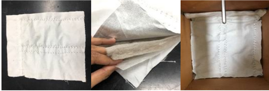
그림. 17 초극세사 솜을 사용한 보온커튼 보온성 시험
