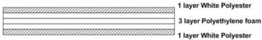
그림. 9 보온커튼 내구성 해석 모델
