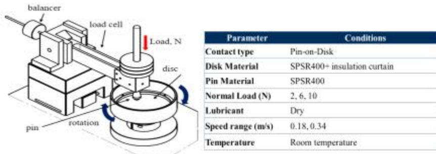
그림. 10 마찰실험 모식도 및 test condition
