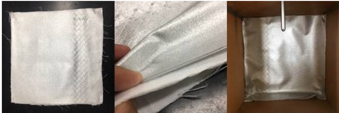
그림. 15 에어로젤과 알루미늄시트를 사용한 보온커튼 보온성 시험
