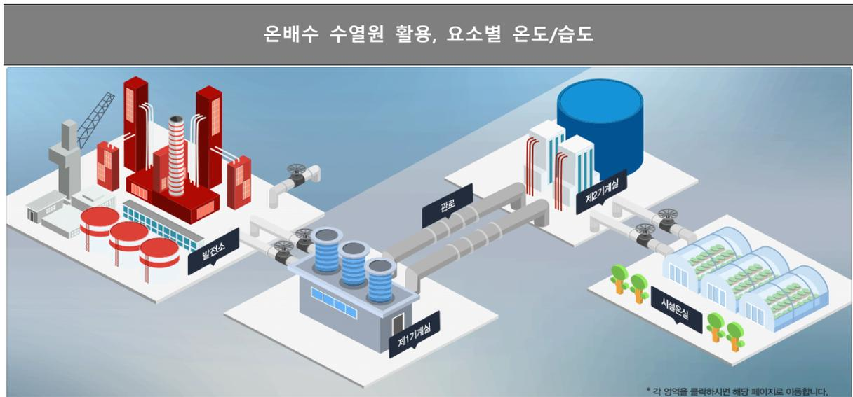
온배수 수열원 제공 및 아열대과수 시설온실에 제공되는 겨울철 가온(난방열원) 활용 및 시스템 운영, 실증을 위해, 당해연도(2018년)의 지점별, 요소별, 설비별 온도/습도 등의 환경데이터 수집 및 온배수 수열원 활용에 따른 시설온실의 가온 상태, 환경정보 분석
