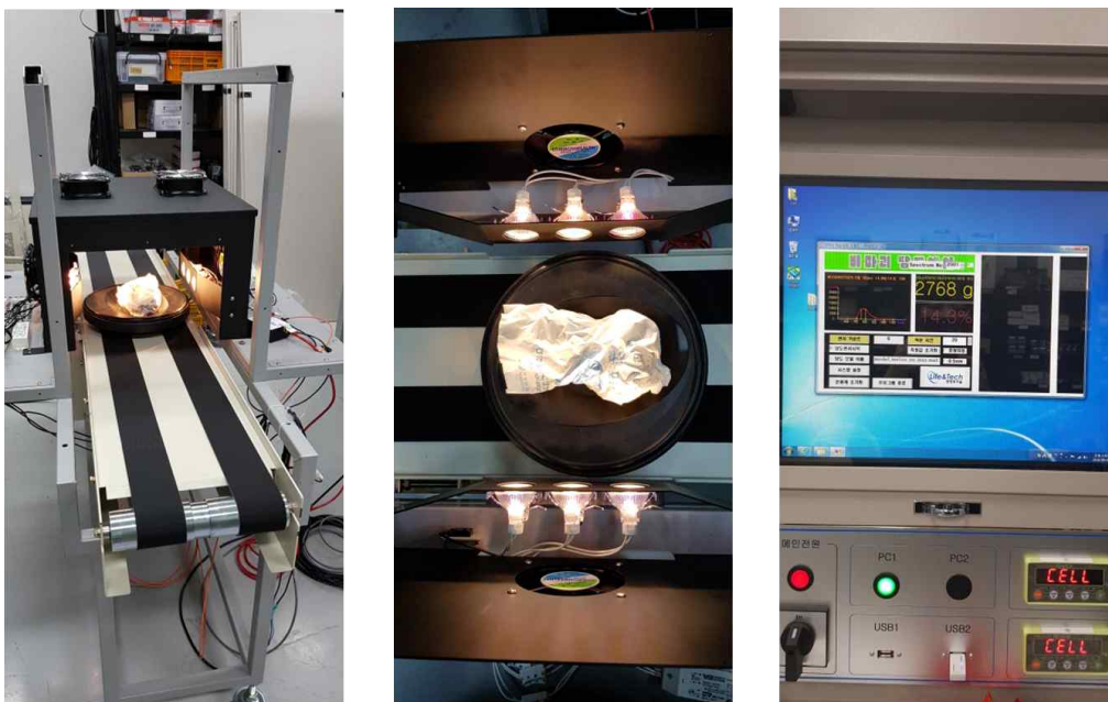
<그림 1> 주관기관이 생명과기술에서 개발한 비파괴 측정장치를 이용한 포도 당도 측정 모습
