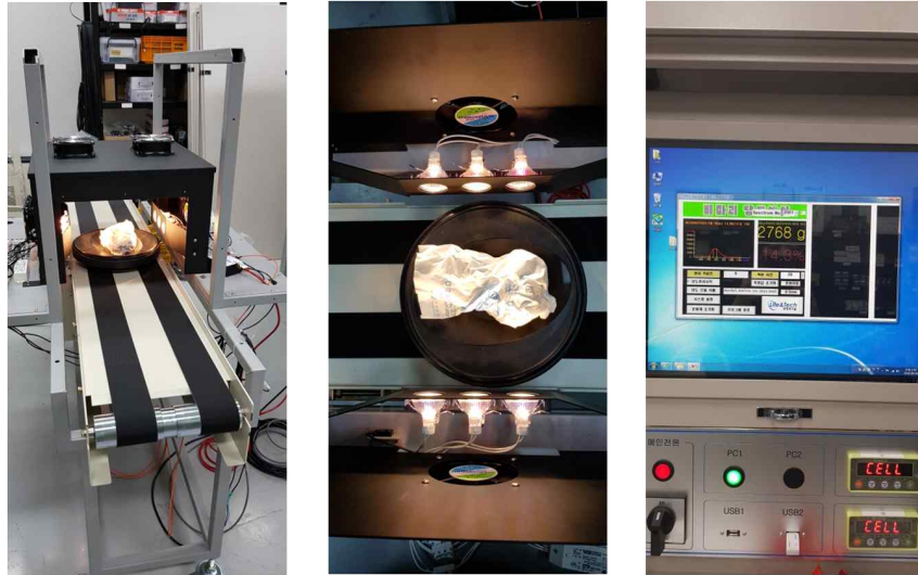
<그림30> 연속식 비파괴 측정 장치를 이용한 포도 비파괴 측정 모습
