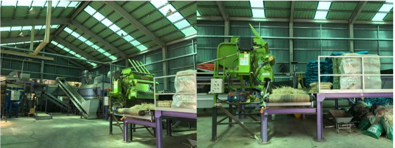
그림 15. 브로콜리 부산물 대량 사일리지 제조에 사용된 TMR 배합기
