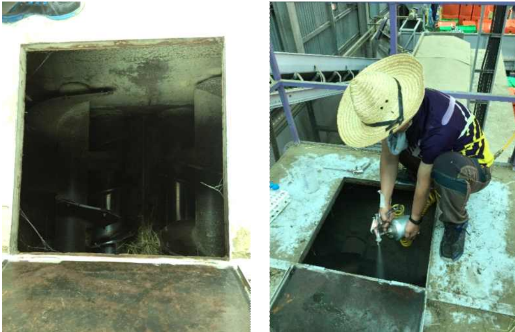
그림 17. 브로콜리 부산물의 절단, 부형제와의 혼합 및 접종원 처리
