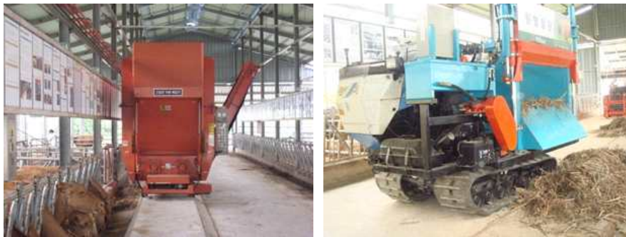
<기존 TMR 배합기 작업>
