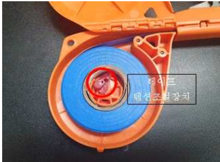
그림 3-29. HT-R 테이프케이스 내부의 텐션조절장치
