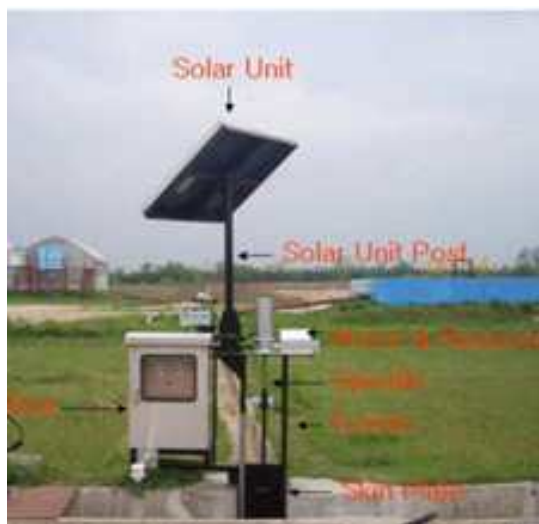
[그림 2-3-18] 태양광 사용 동력식 수문
