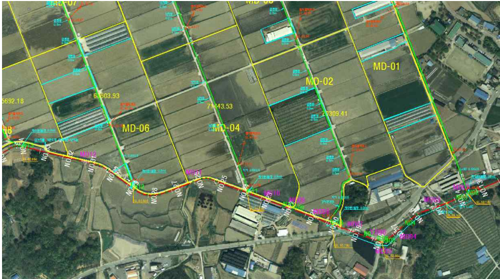
[그림 2-2-39] 농업용수 네트워크 모형 입력자료 구축을 위한 현장조사 반영 도면 (MD-01~MD-06 분기 구간 확대)
