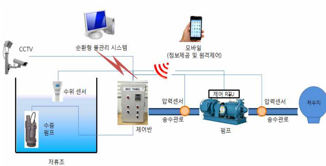
[그림 1-2-7] 순환형 농업용수 관리 원격제어 시스템 개념도
