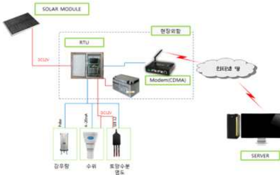
[그림 2-7-13] 계측자료 데이터 전송 시스템 구성도
