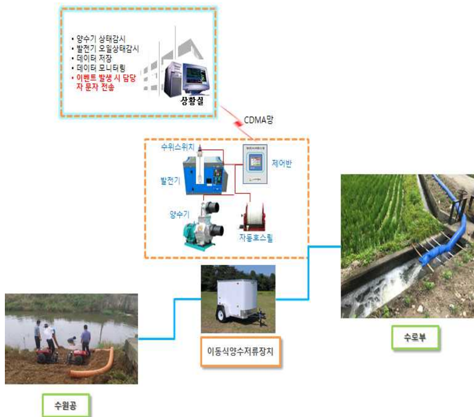
[그림 2-7-47] 이동형 양수장치 구성 및 활용 개념도
