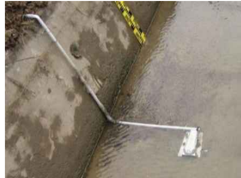
[그림 2-3-10] 도플러식 유속계 원리 및 형태(예시)
