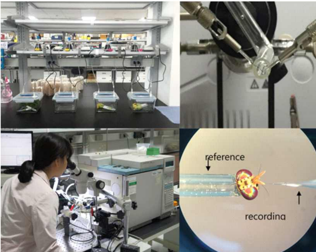
Figure 3-2. 호박과실파리의 기주식물로부터 발산되는 냄새물질들을 포집하기 위한 dynamic headspace volatile collection system (좌상), GC-EAD 시스템 (좌하), GC로부터 분획되어 나오는 물질들을 호박과실파리 안테나로 보내기 위한 main airflow tube 및 안테나와 작은턱수염으로부터의 신호를 측정하기 위한 기준전극과 기록전극 (우상), 그리고 호박과실파리의 안테나와 작은턱수염으로부터의 신호를 측정하기 위해 머리를 분리하여 기준전극의 electroconductive gel과 기록전극에 연결한 모습 (우하).
