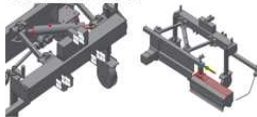
(a) 구속 조건 (b) 하중 방향 그림.2 구속 조건 및 하중 방향
