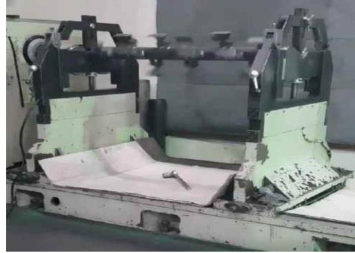
진동방지 배런싱 작업
