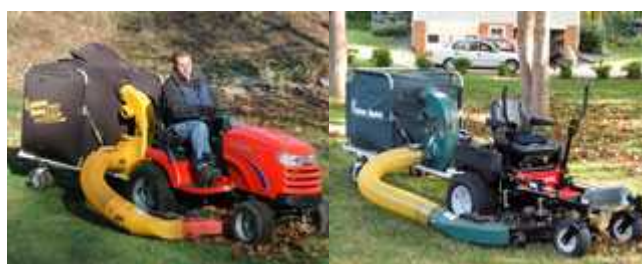
그림 2-6, 트레일러 부착 형태의 잔디 포집장치
