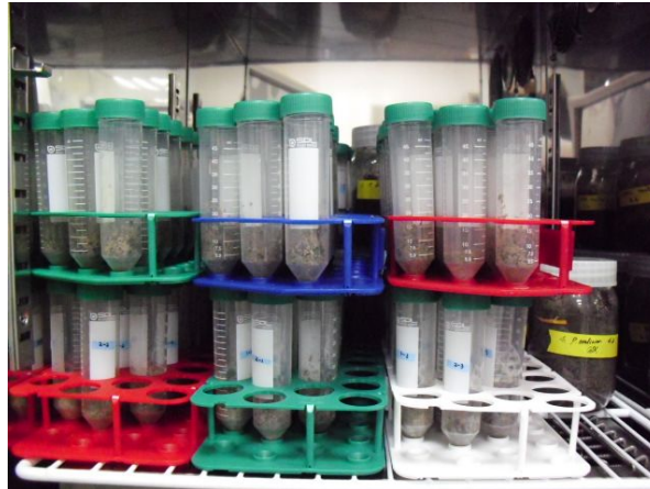
그림 3-45. 온도와 습도조절이 가능한 고상발효 모델
