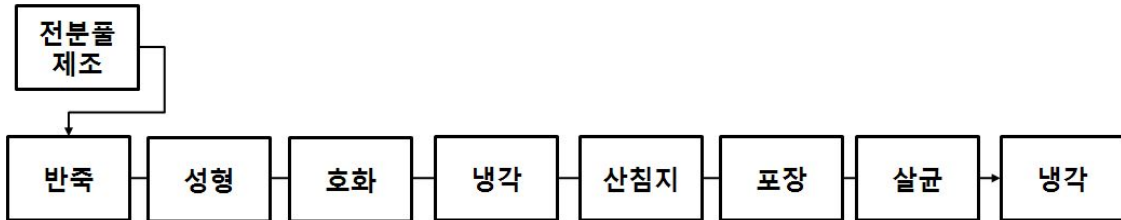
그림2. 자연낙하법을 이용한 즉석 편의형 생당면의 제조 방법
