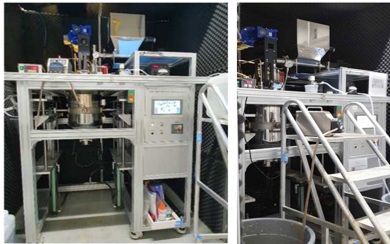
<그림 20> 파일럿 장치를 이용한 알칼리 침출 공정 실시
