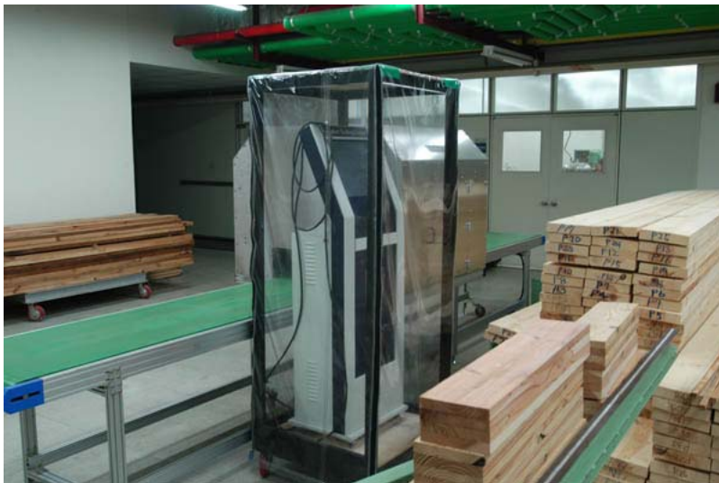
그림 105. 목재 검색장치를 이용한 목재강도 추정 시스템.
