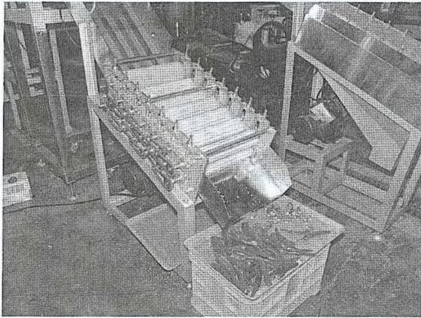
그림 6-14. 생고추 원료 꼭지 제거 시스템 2차 시작품의 성능실험 과정(1차 실험)
