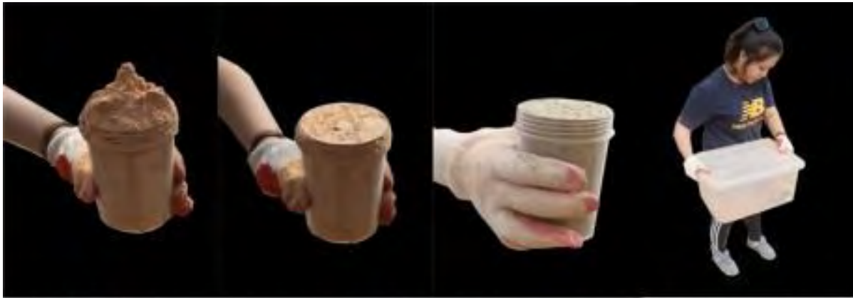
고운흙을 통안에 채움 윗 면을 평평하게 정리 모래도 흙과 같이 준비 흙+모래를 흔들어 섞음
