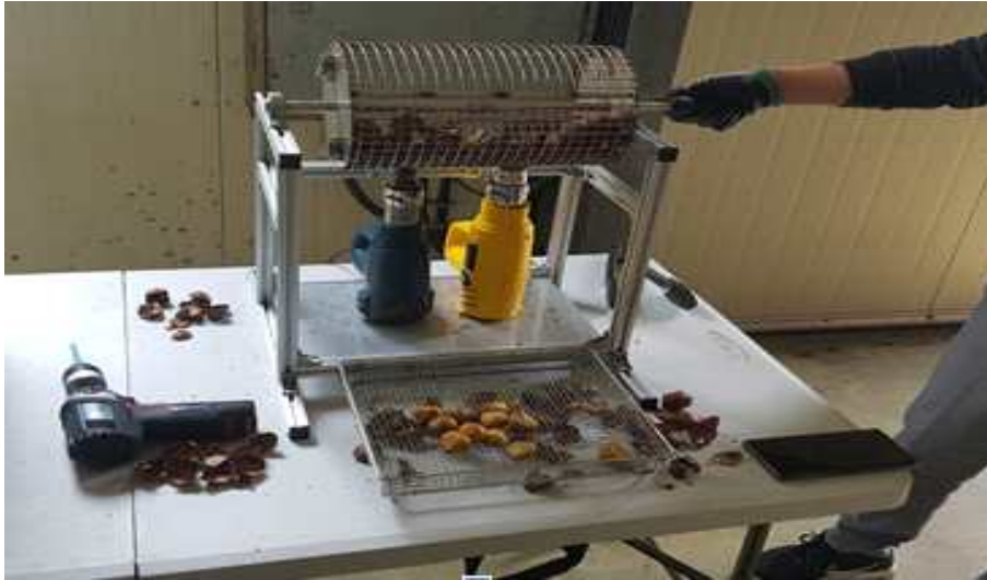
그림 124. 블로워 실험장치 실험 사진
