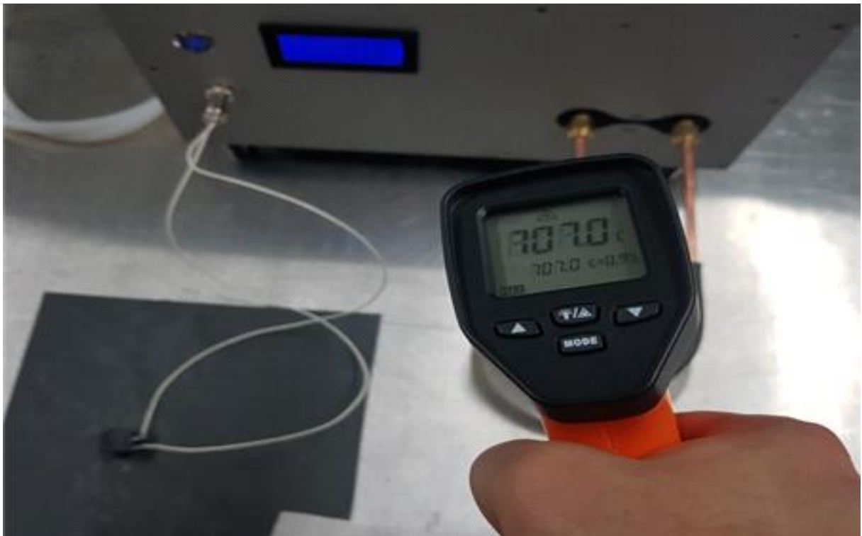
그림 42. 목표온도 달성 시험
