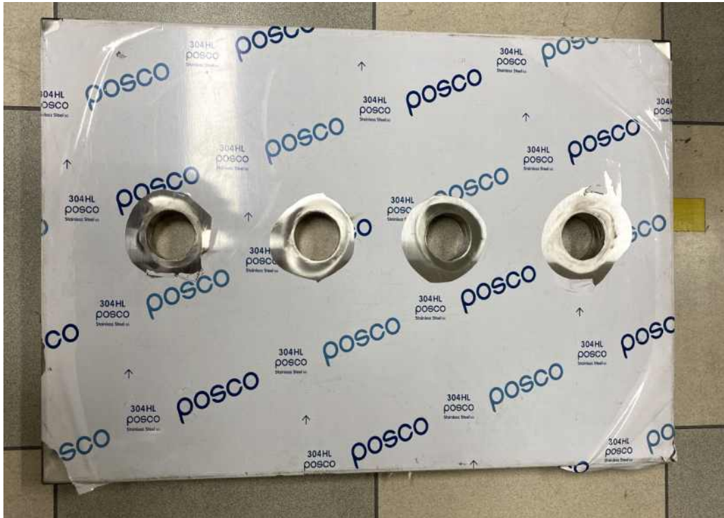
그림 107. 고주파히터 코어 장착 판넬
