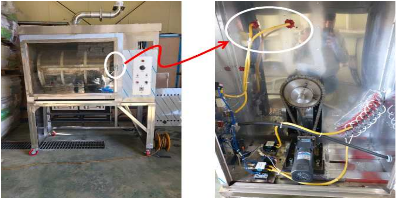
그림 68. 내부온도 측정을 위한 열전대 설치 위치
