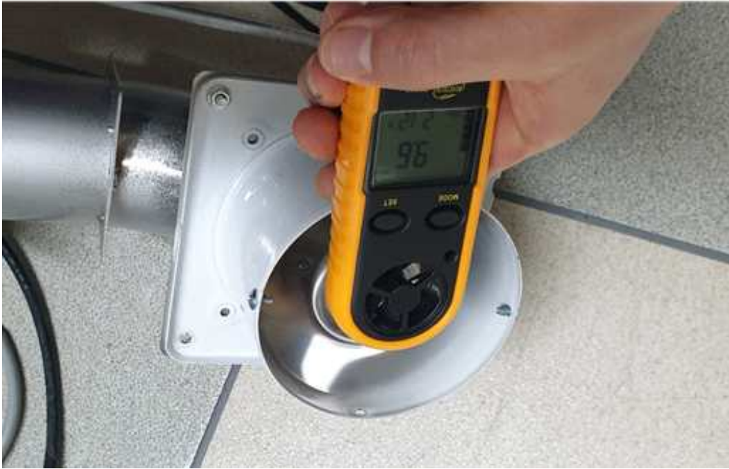
그림 66. 환풍장치 풍속 측정 실험
