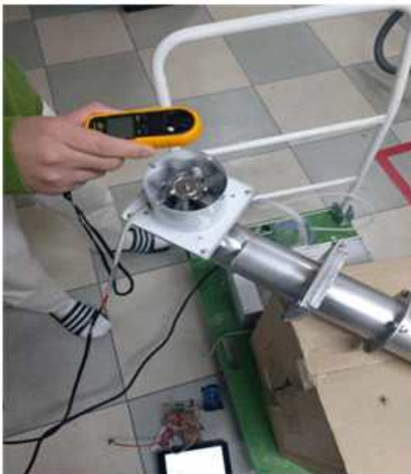
그림 67. 환풍장치 풍속 측정 실험
