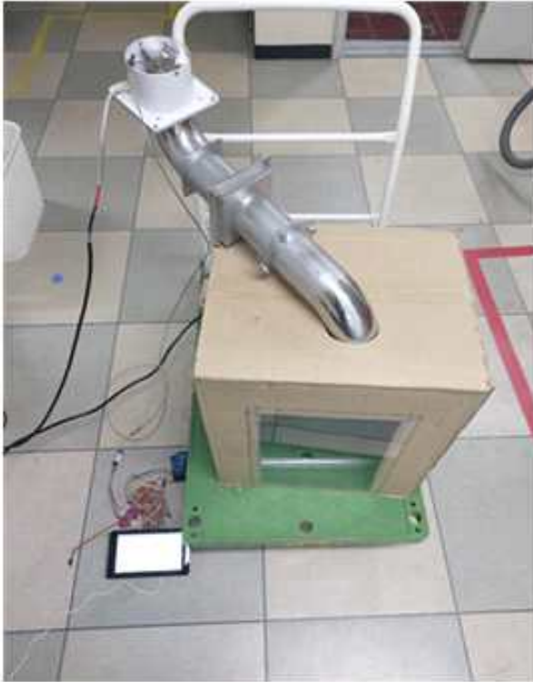
그림 62. 환풍장치 온도 측정 실험 화면
