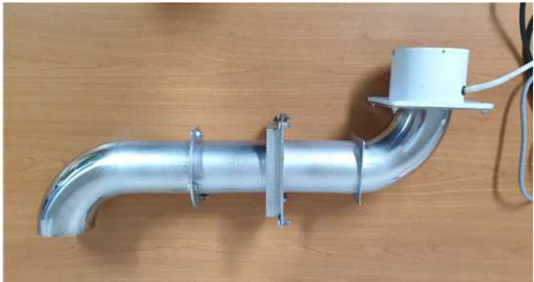
그림 111. 연통 및 필터 조립 사진
