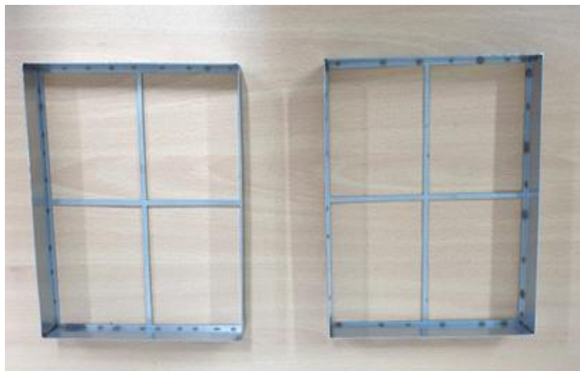
그림 74. 필터 장착 전 인증시험용 지그
