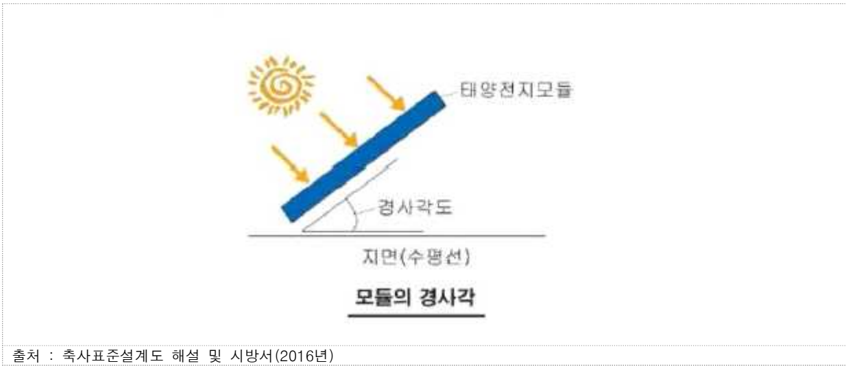
[그림 3-12] 태양전지의 설치
