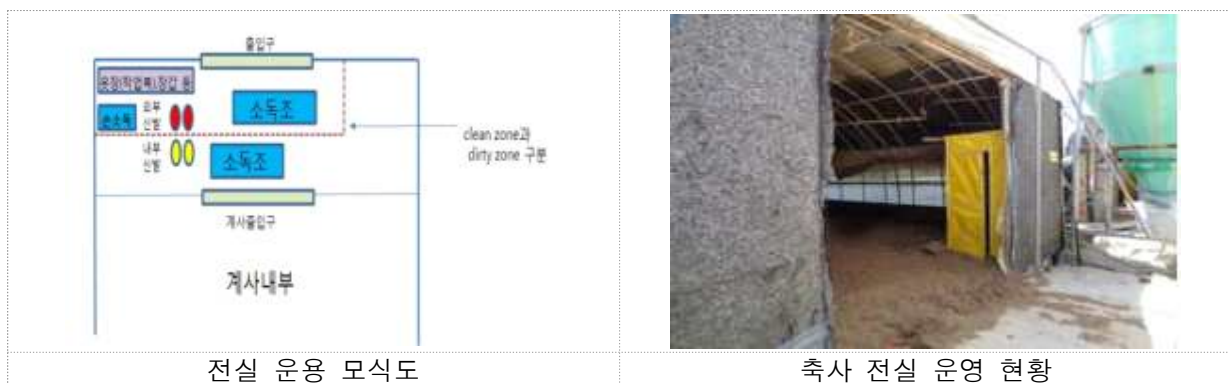
[그림 3-9] 축사 입구 전실 설치
