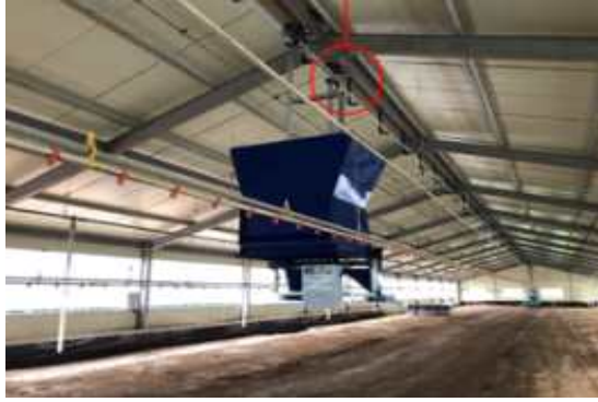
[부록 그림-34] 오리 농장의 차세대 ICT장비 중 왕겨살포로봇 및 살포장면
