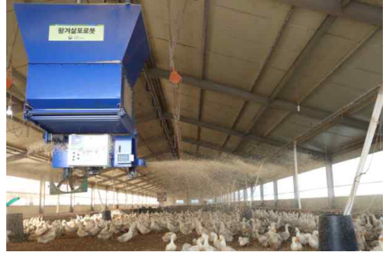
[부록 그림-34] 오리 농장의 차세대 ICT장비 중 왕겨살포로봇 및 살포장면
