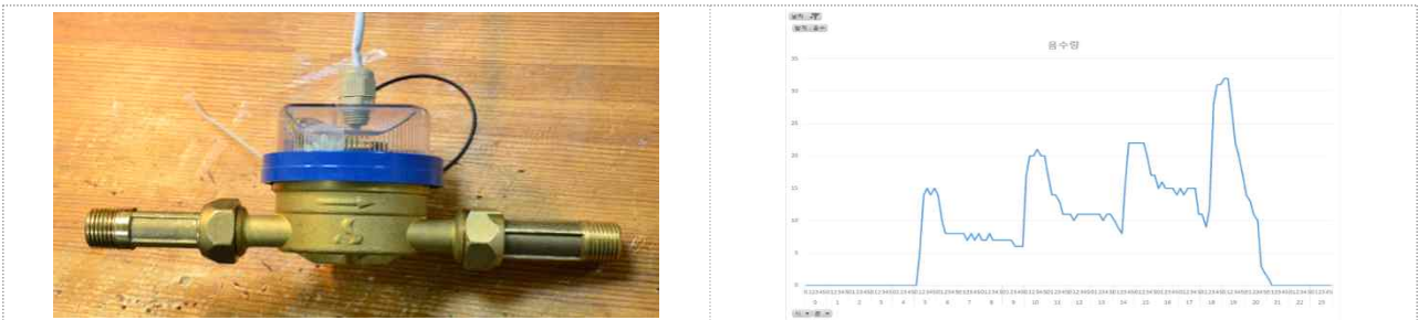
[부록 그림-22] 음수량 측정 센서(건식 수도메타+측정센서)와 측정 사례
