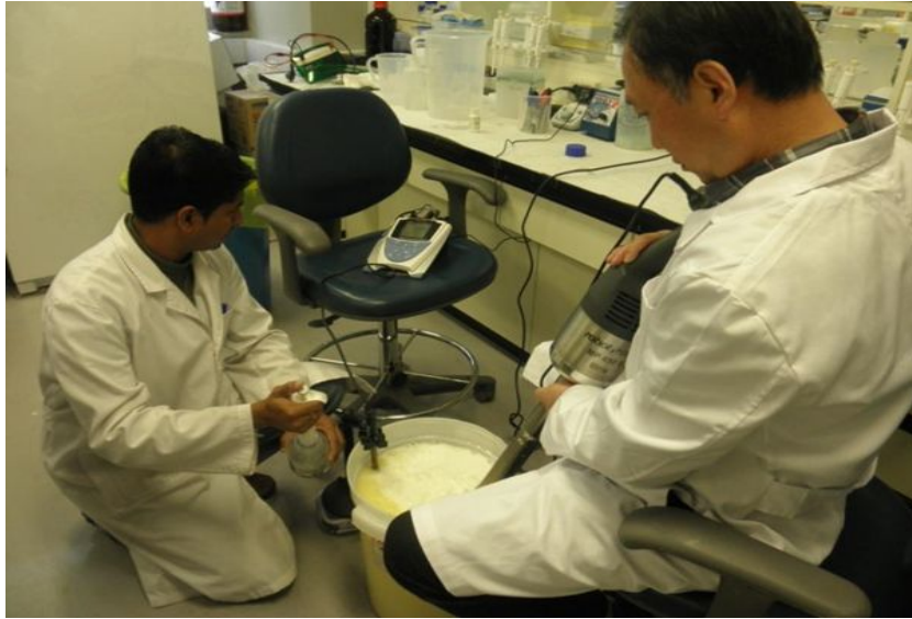
Fig. 57. 난백을 증류수로 희석하여 교반시킨 후 pH를 4.5에서 5.0으로 조정하는 과정.
