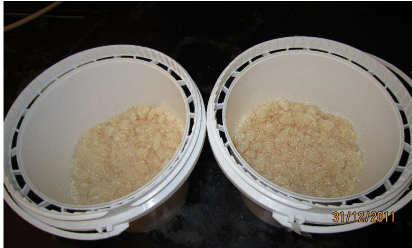
Fig. 37. Batch method를 이용하여 철 이온제거에 이용될 AG1-X2 resin.
