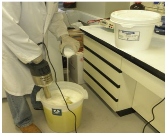
Fig. 58. 원심분리 후 얻어진 상층액에 5.0%의 ammonium sulfate 와 2.5%의 citric acid 첨가 과정.
