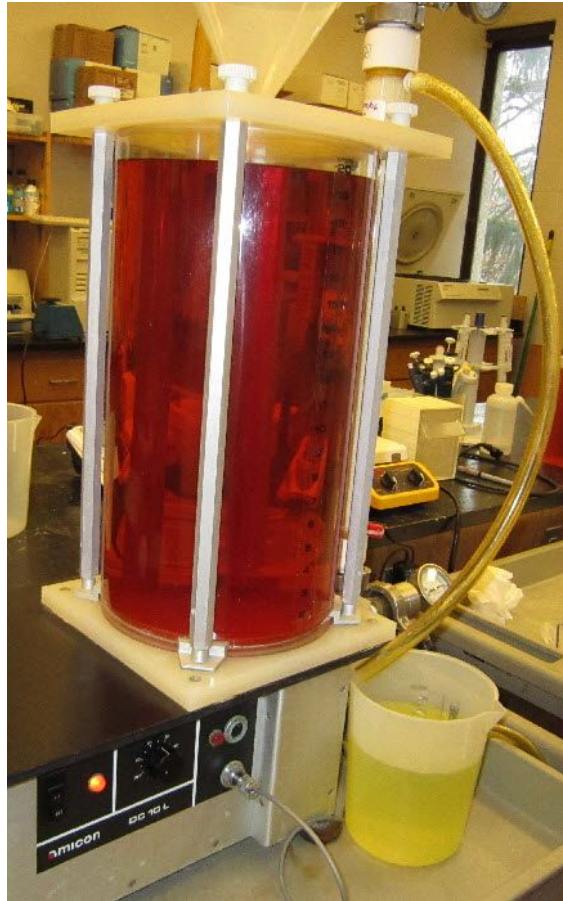
Fig. 35. Ovotransferrin solution을 ultrafiltration을 이용하여 에탄올을 제거하고 농축하는 과정.
