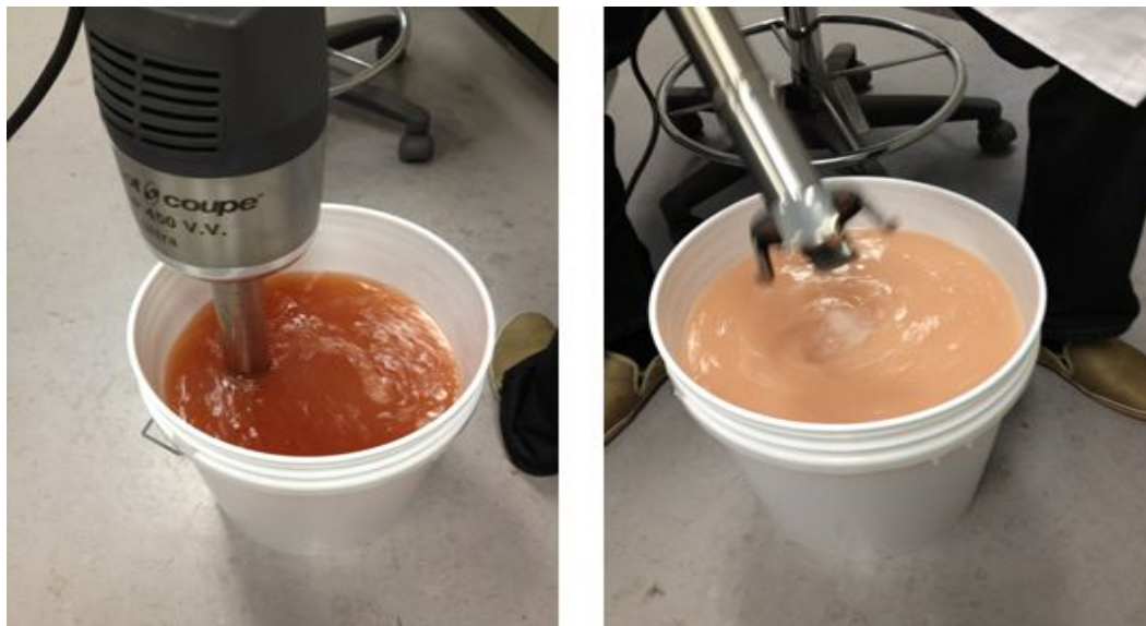
Fig. 54. 모은 상층액을 다시 61%의 에탄올 농도를 이용하여 교반하는 과정.
