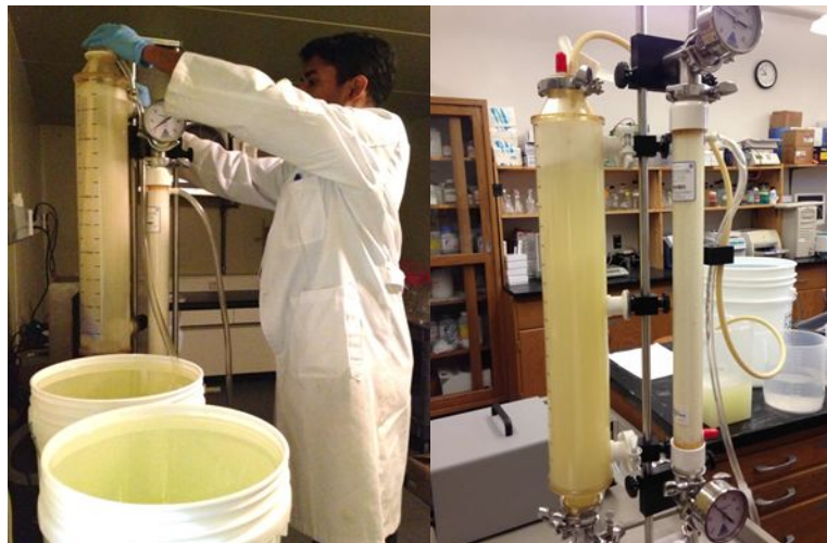
Fig. 60. Ovotransferrin 침전물을 증류수에 녹인 후 ultrafiltration을 이용하여 염 제거 및 농축하는 과정.
