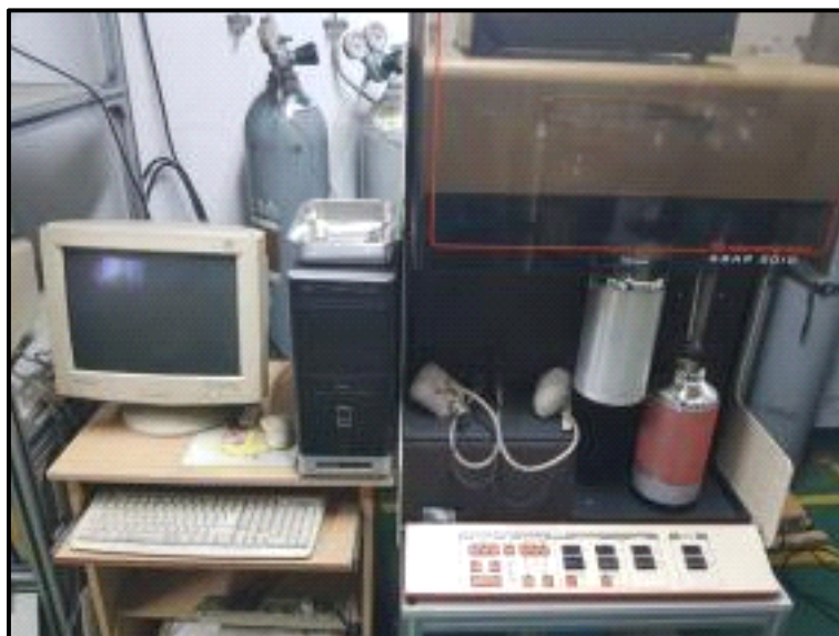
그림 2-1-2. 비표면적 측정 장치(Micromeritics Co., ASAP 2010)
