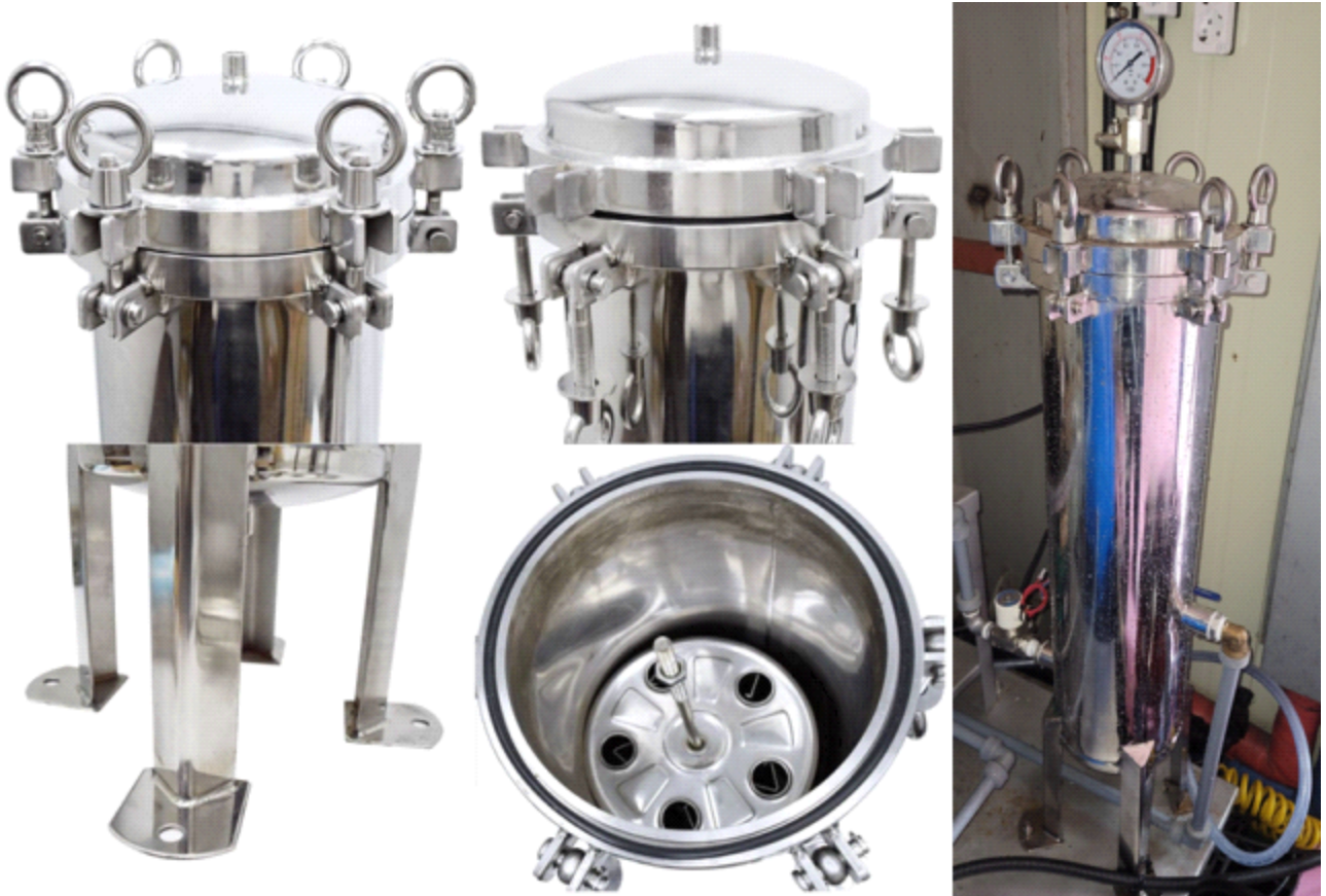
그림 2-1-27. 노즐시스템 전처리 필터 하우징
