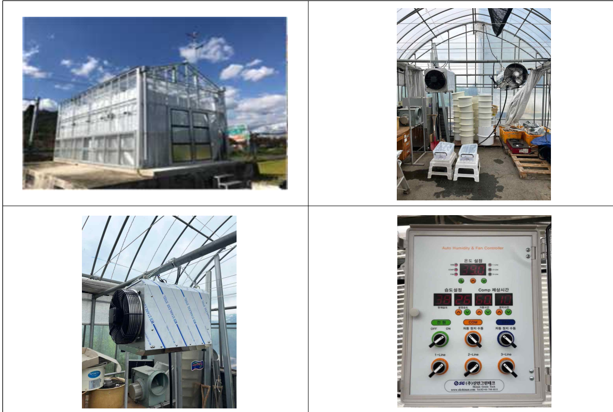
<외부 환경조건 및 Raw-Data 기록이 가능한 8평 Test-room(하우스 형태)>
