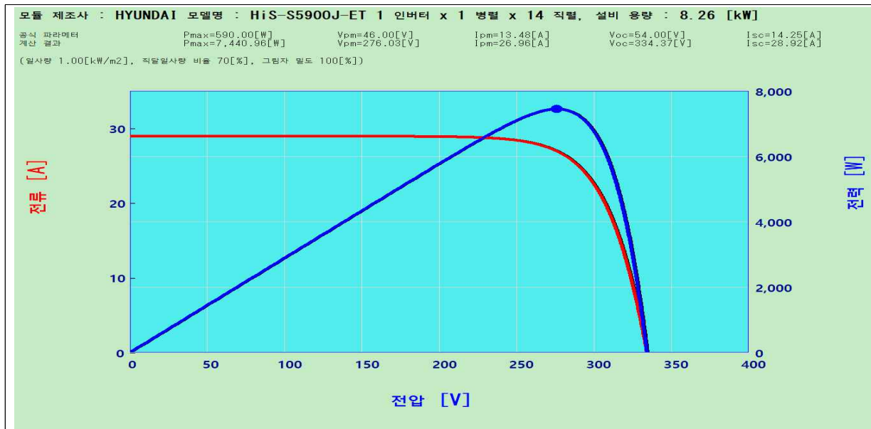
Figure 175. 사용된 태양광 패널의 I-V curve 및 전체 연결의 전기적 parameters
