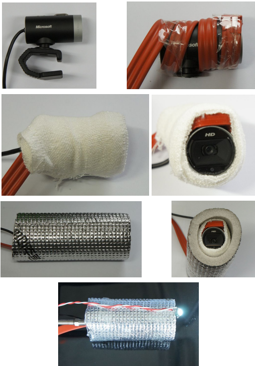
그림 26. 고내 성에 착상/ 제상 측정을 위한 카메라 시스템
