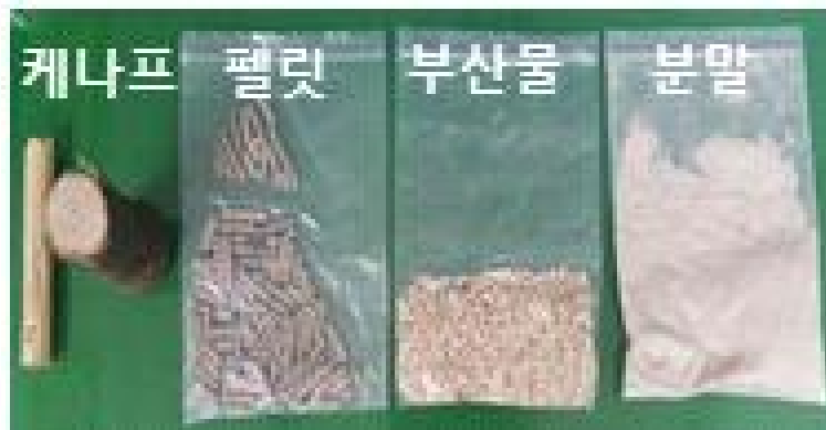
<그림 3-5> 케나프 가공에 따른 펠릿, 부산물, 분말 형태
