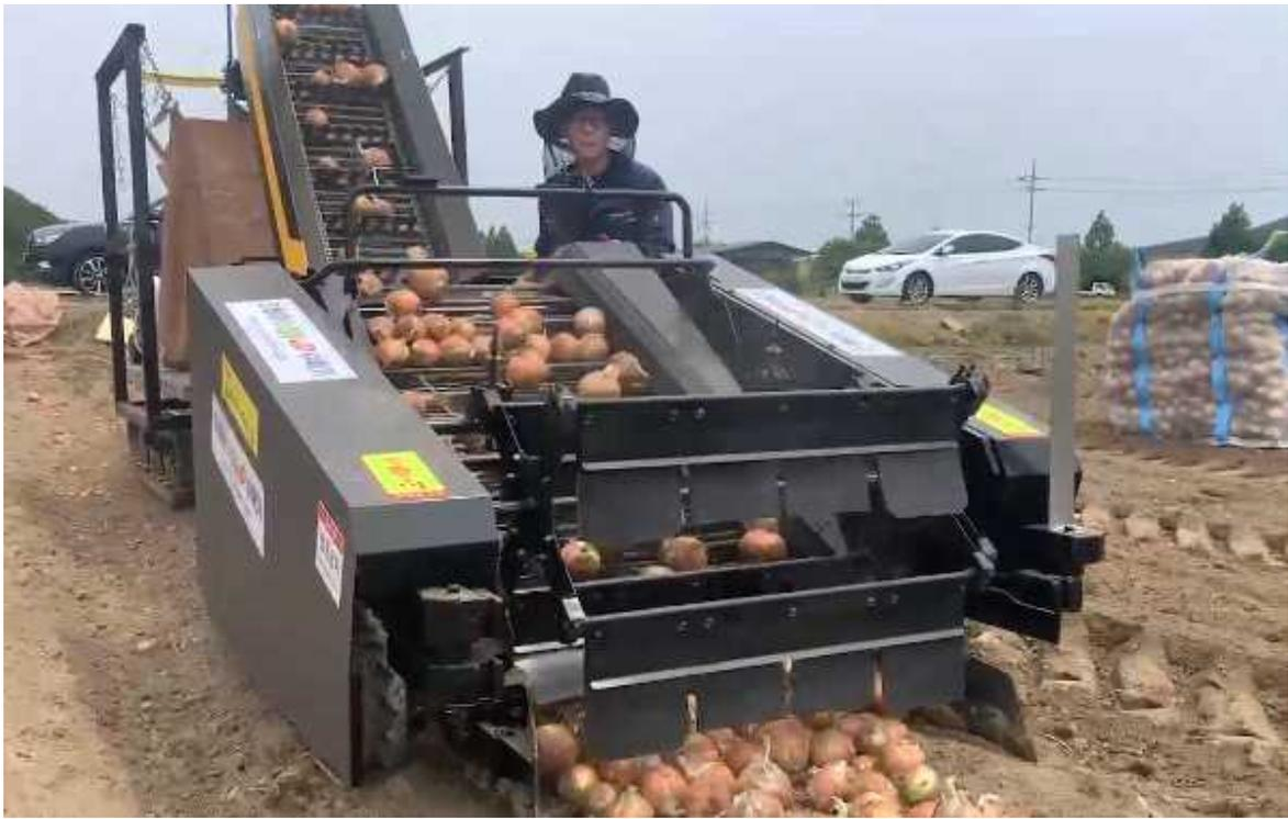
그림 26 이송본체 상기안내부 설치 후 양파 요인시험
