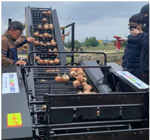
그림 20 이송본체 - 이송부 테스트 시 사진
