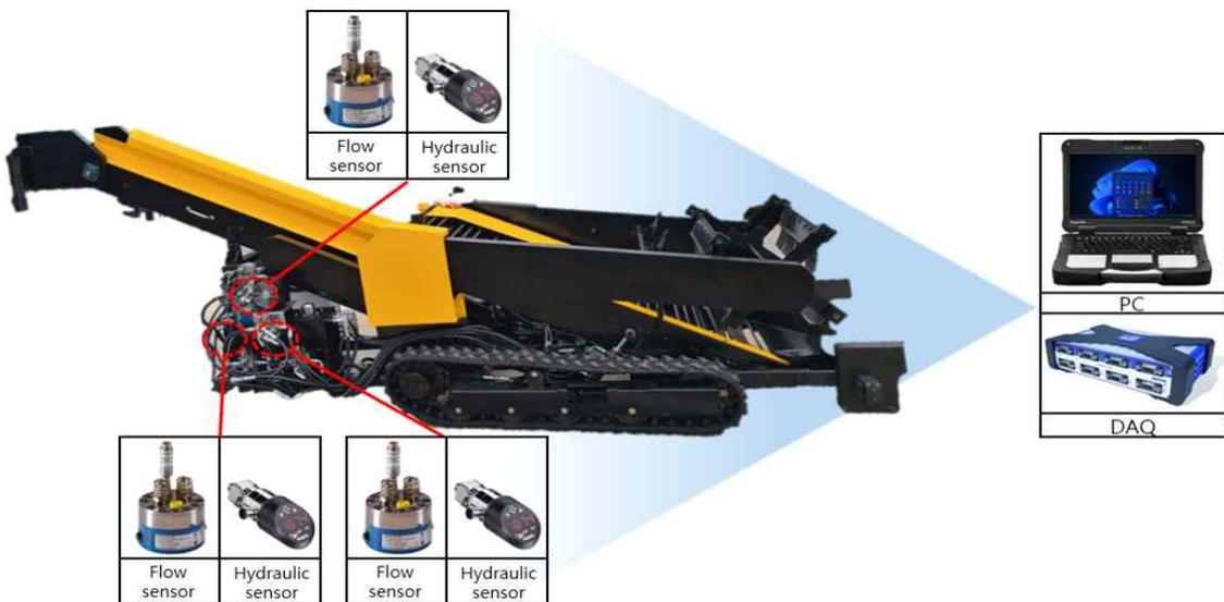
그림 87 양파 수집기의 유량 및 유압센서 설치 layout
