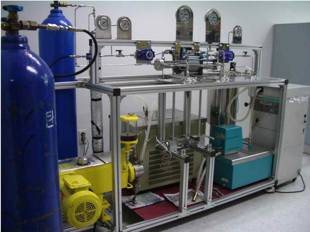
그림 3. Apparatus for supercritical carbon dioxide extraction
