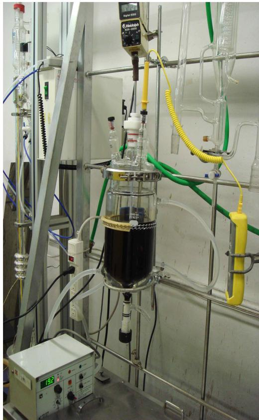
그림 9. Acid Hydrolysis 화학 반응기
