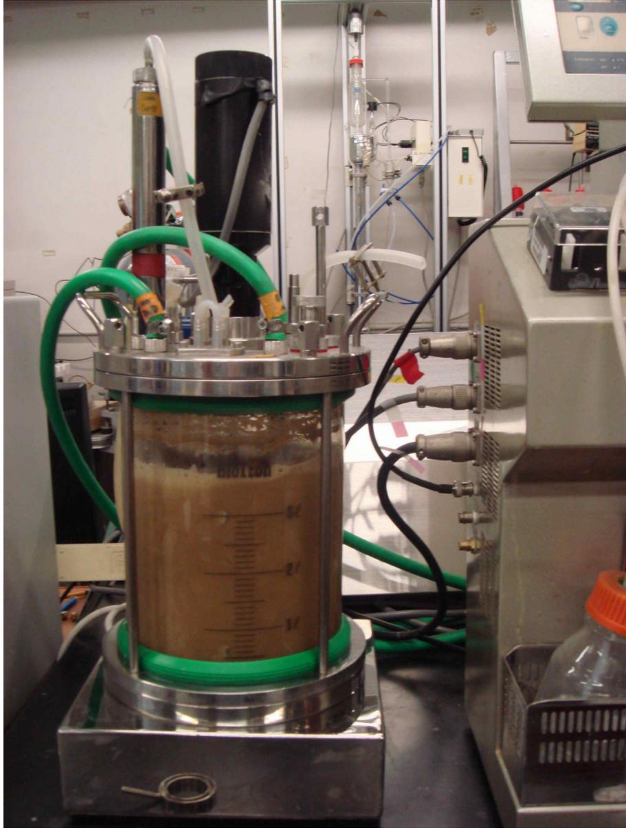
그림 12. 쌀 단백질을 이용한 천연 eHVP 생산을 위한 3 liter 효소반응기
