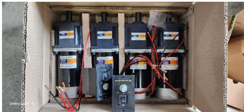
그림70. 전동모터 및 감속기 DC24V 200W, 50:1
