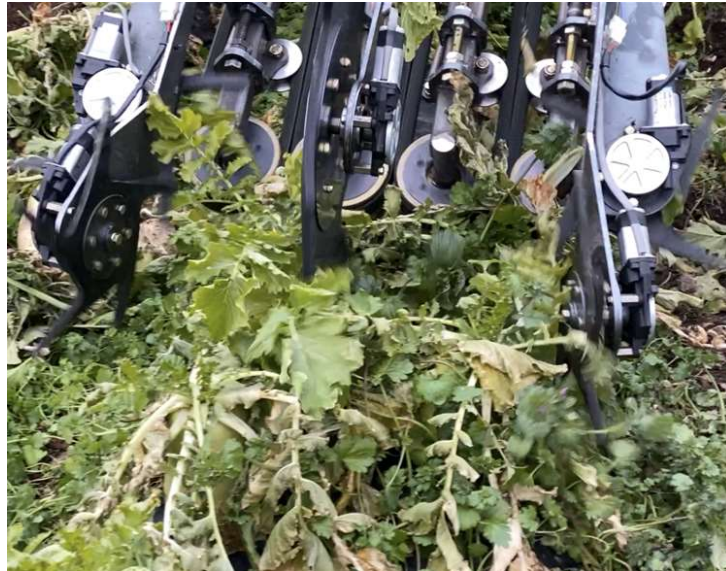
그림 10. <작동 중인 인발 진입부의 견어올림용 고무 러그>
