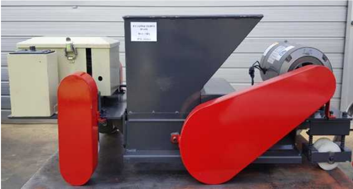
〈그림 3-28〉 쌀기 고설재배용 전동관리기 시작기(2) 조립 사진
