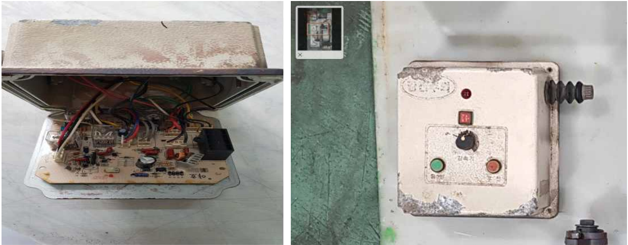
<그림 3-8> 로터리 컨트롤러 및 모터 감속기
