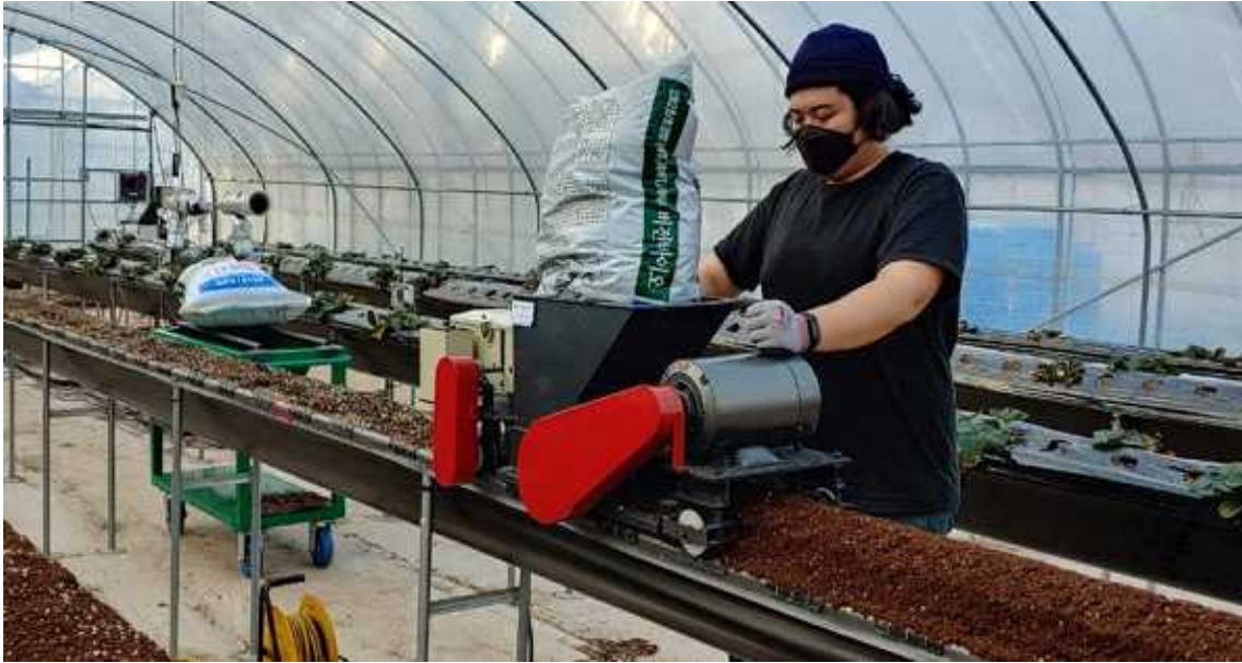
<그림 3-42> 딸기 고설재배용 전동관리기 실증시험
