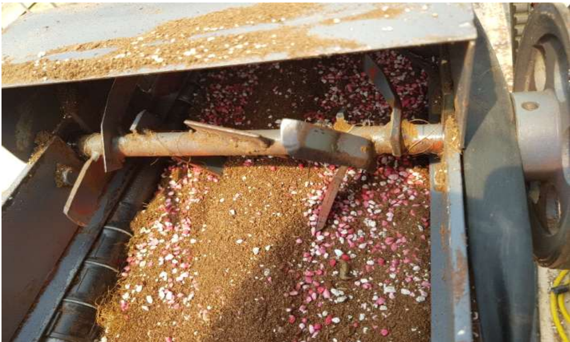
<그림 3-13> 로터리 칼날 및 시제품 결합
