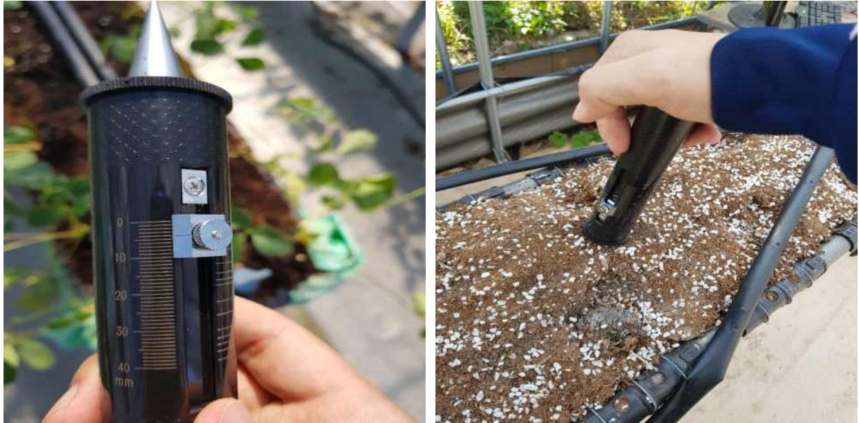
〈그림 3-25〉 경도계를 이용한 측정
