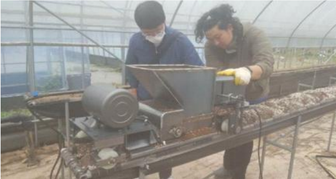
<그림 3-14> 딸기 고설 재배용 전동관리기 실증시험 I
