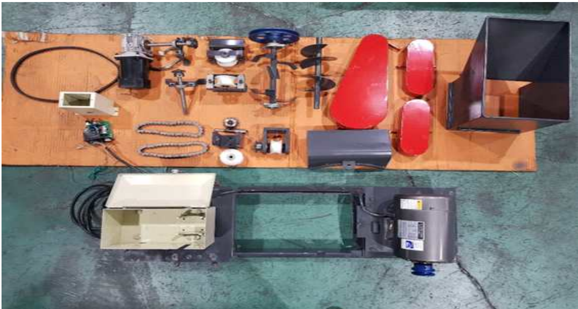
<그림 3-27> 딸기 고설재배용 전동관리기 시작기(2) 조립 준비 사진
