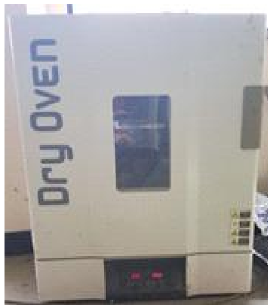
<그림 3-54> 함수율 측정 사진
