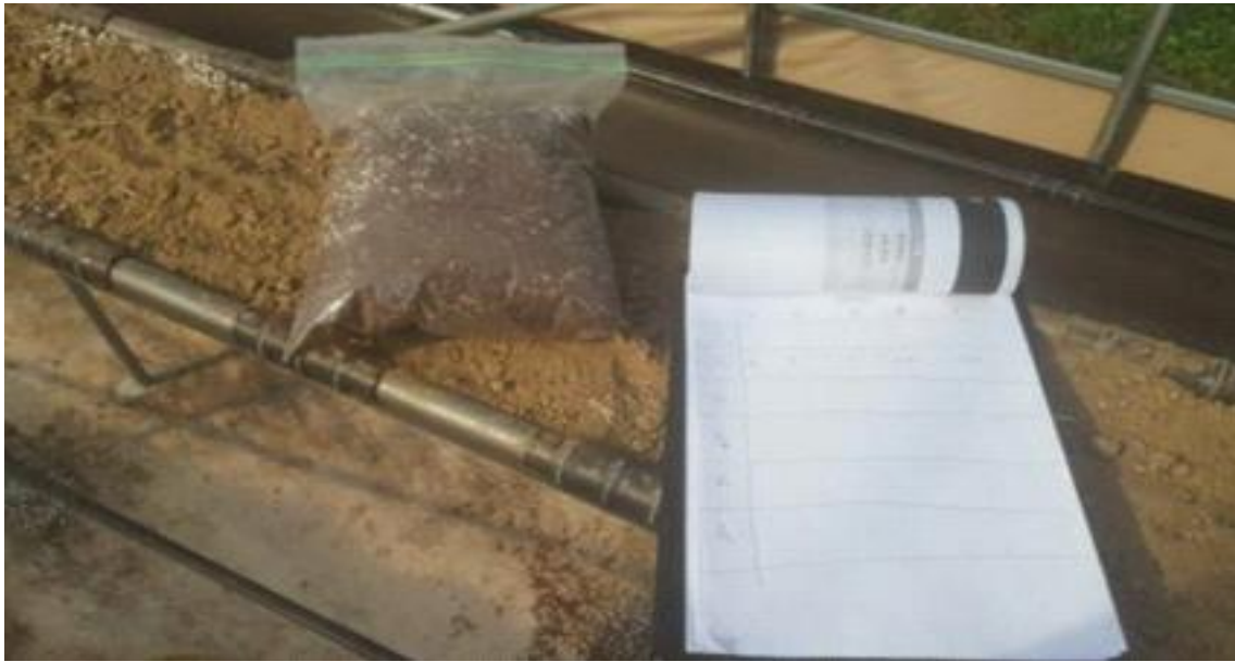
〈그림 3-52〉 작업 전 재사용 상토 및 새 상토의 3상 측정
