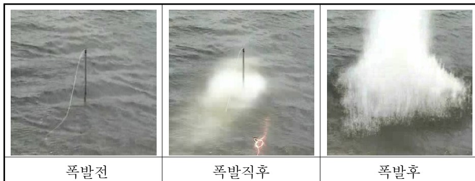
<그림 7-43> 권선형 스크린(200mm) Pilot 폭약시험 결과
