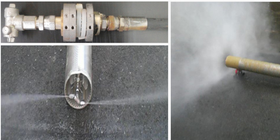
<그림 7-28> 공주 집수정2번 우물재개발용 워터젯팅 및 작동사진
