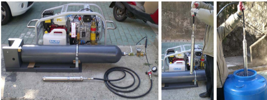
< 고압컴프레서 및 고압충격발생기 구성품 및 시험설치 사진 >
