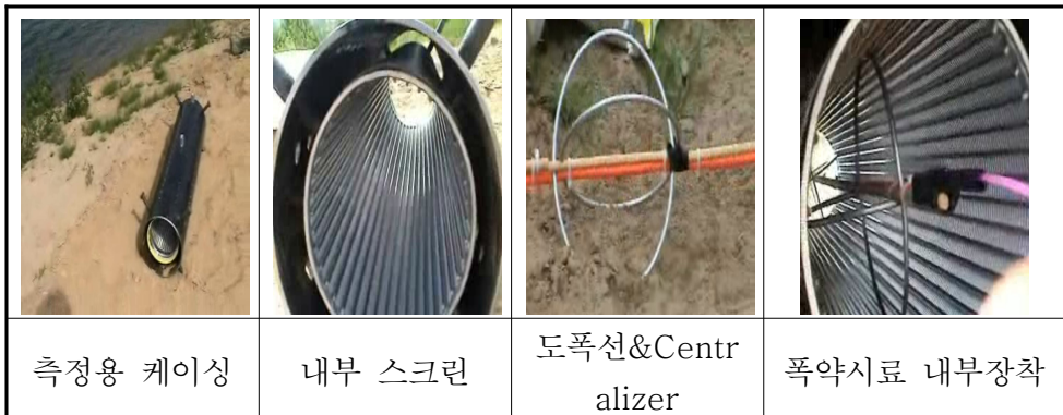
<그림 7-42> 권선형 스크린(200mm) Pilot 폭약시험
