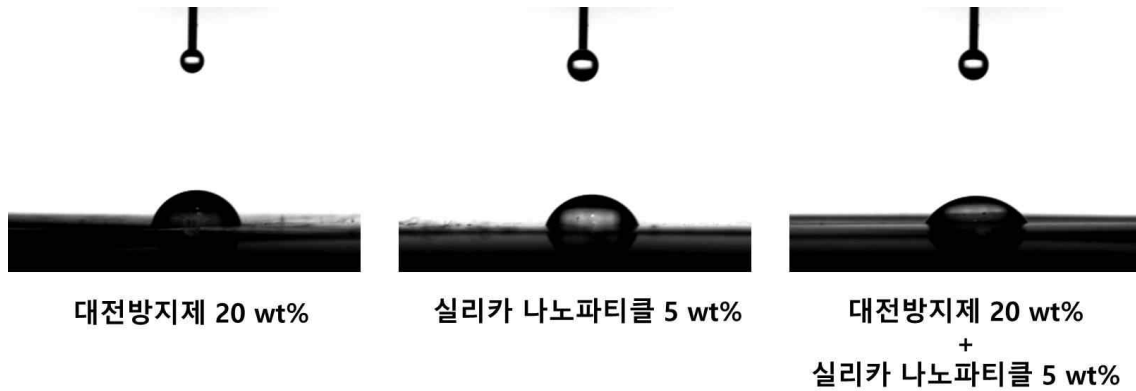
그림 35. 첨가제에 따른 static water droplet 사진
