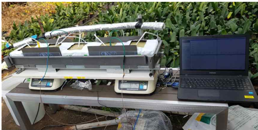
그림 3-3-47 정전용량 센서의 함수량 정량화 실험장치 사진
