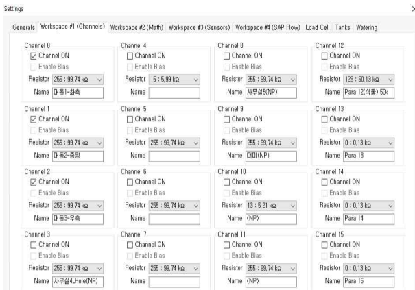
그림 3-3-9. 함수량 센서 선정: 최대 16채널 (Setting-Watering)
