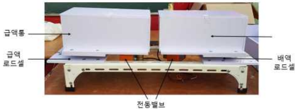
급/배액통에 전동 밸브 및 로드셀을 설치한 사진
