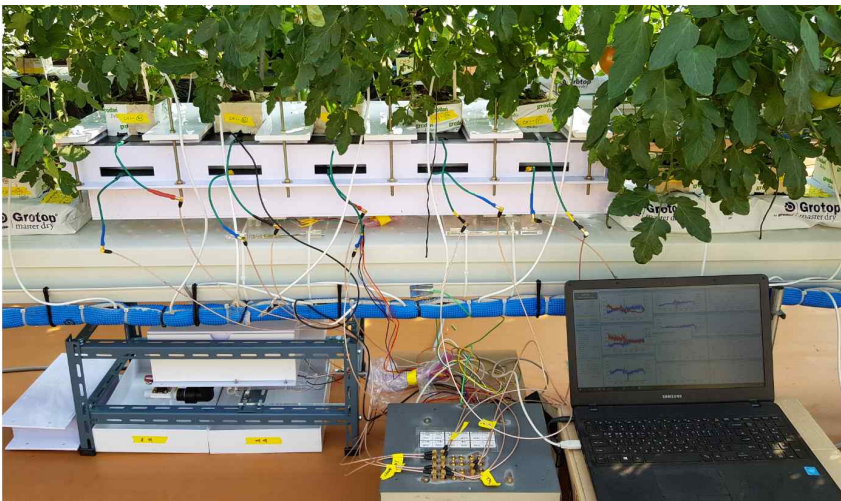
그림 3-1-15. Load cell이 장착된 배지 함수량 측정 장치
