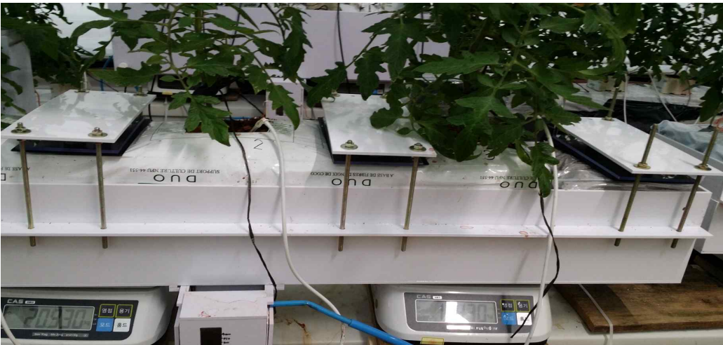
그림 3-1-14. 상용전자저울이 장착된 배지 함수량 측정 장치
