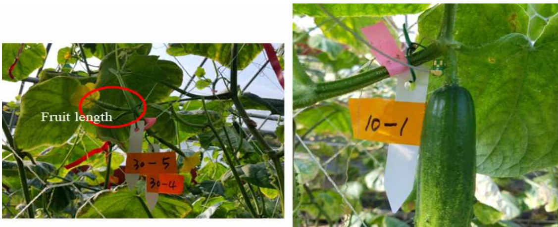
그림 2-1-13. 오이 과실 길이 측정(좌)과 과경에 삽입한 수액흐름 센서(우)
