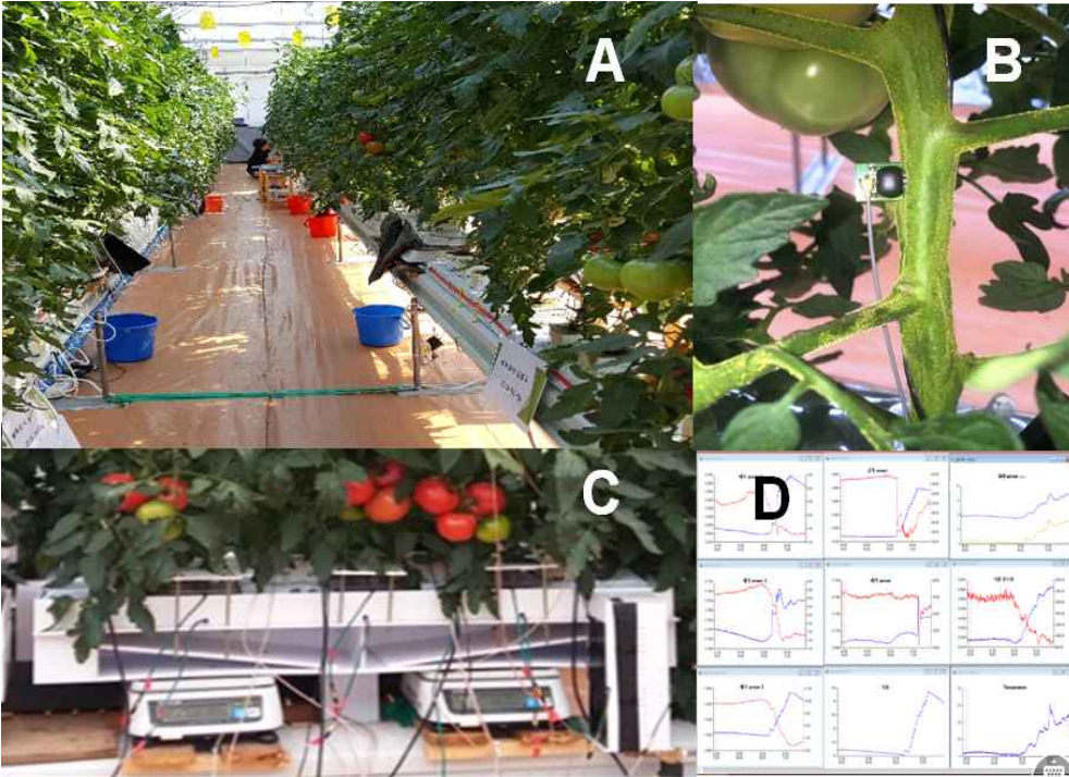
그림 1-1-1. 급액제어방식(ISR, SF, SWC)으로 재배된 토마토 생육(A), 물관수액흐름센서(B), 배지수분측정장치장치(C), 배지수분센서장치에서 실시간 센싱한 수분변화(D)
