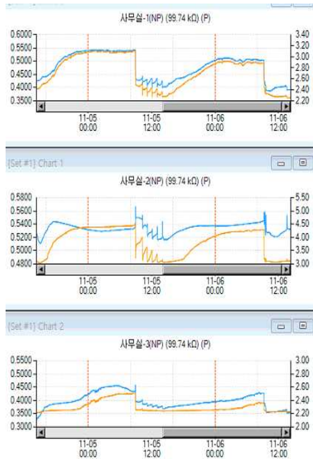
그림 3-1-5. 접지 개선 후 함수량 신호
