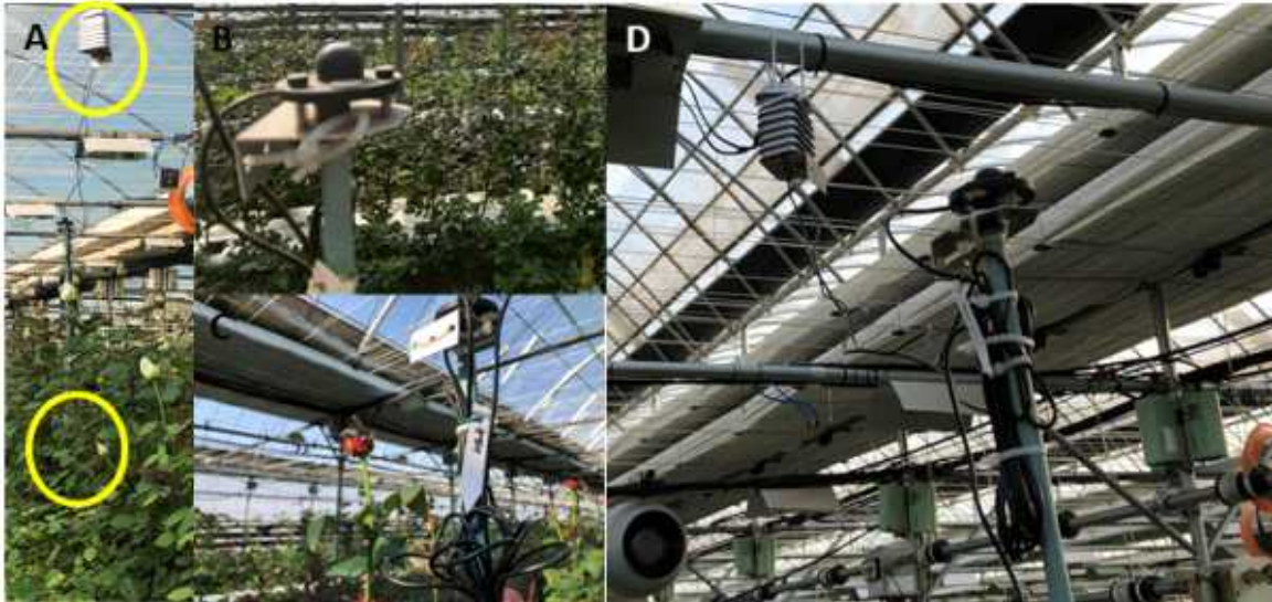
그림 26. 환경 센서 및 데이터로거(A, D: 데이터로거 센서, B: 광센서, C: 배지센서)
