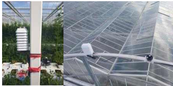
그림 63. 스프레이 장미 스마트팜 내·외부 센서 설치 모습
