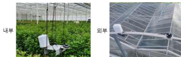
그림 75. 스마트팜 내부와 외부에 설치되어 있는 데이터로거 모습
