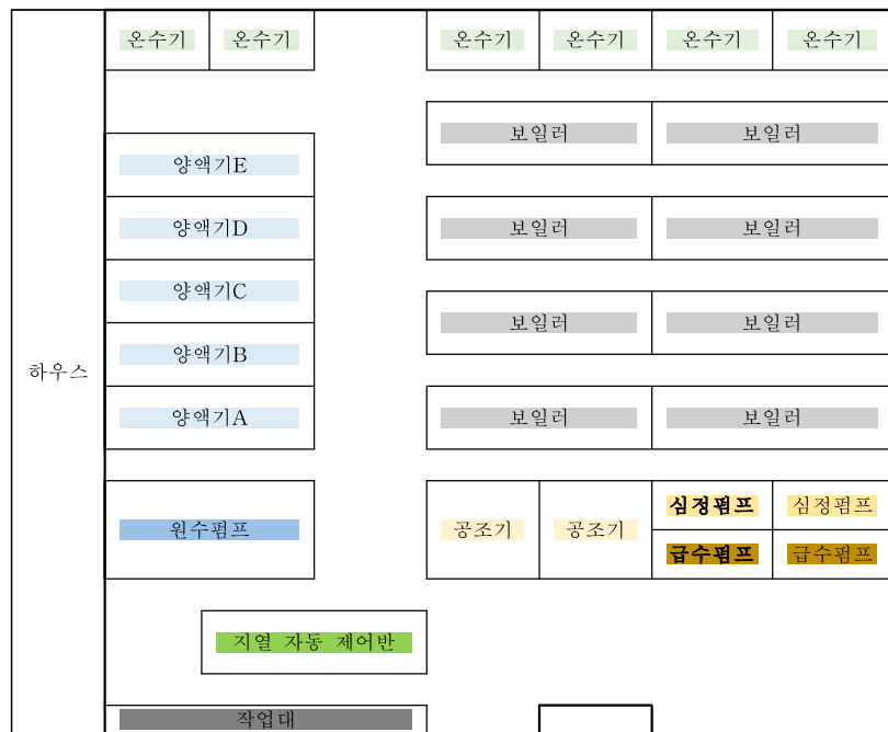
그림 60. 스프레이 장미 스마트팜 내부장치 모식도
