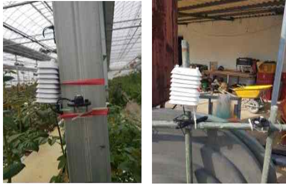
그림 62. 스탠다드 장미 스마트팜 내·외부 센서 설치 모습
