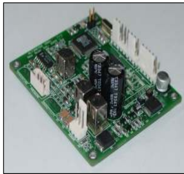
<그림 2-9> 음향 측심 센서 및 제어보드 형상
