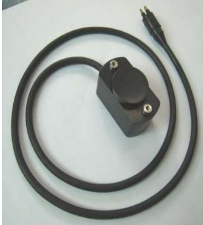
<그림 3-48> 음향측심센서 및 제어보드 형상
