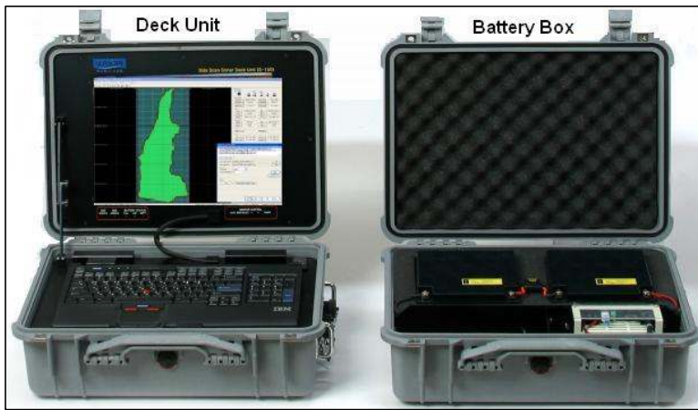
<그림 2-11> Deck Control Unit 및 Battery Box 형상
