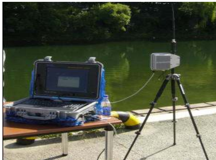
<그림 3-53> 육상 기지국의 Deck Unit 실제 모습
