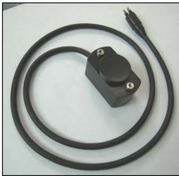
<그림 2-9> 음향 측심 센서 및 제어보드 형상
