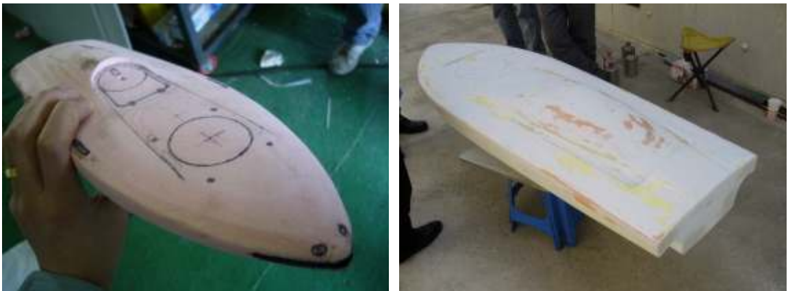
<그림 3-30> 선체 설계용 목업과 몰드 제작
