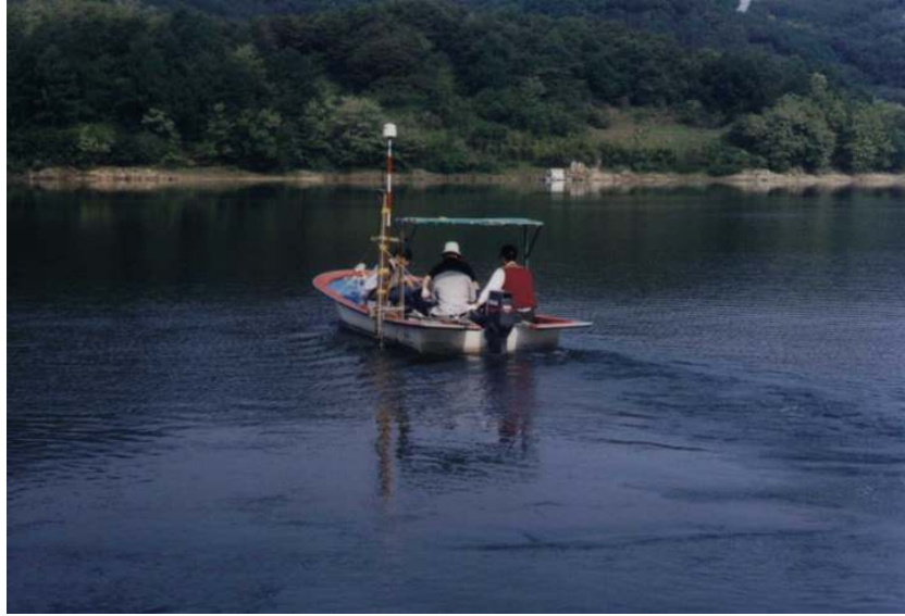
<그림 3-2> GPS(Beacon GPS)와 컴퓨터를 이용한 수심측량 전경
