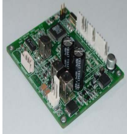
<그림 3-48> 음향측심센서 및 제어보드 형상
