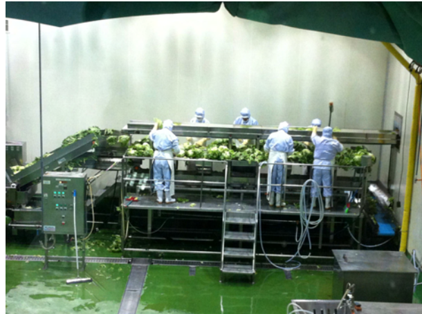
Fig. 3-155. 신선편이 양상추의 선별 및 절단 공정
