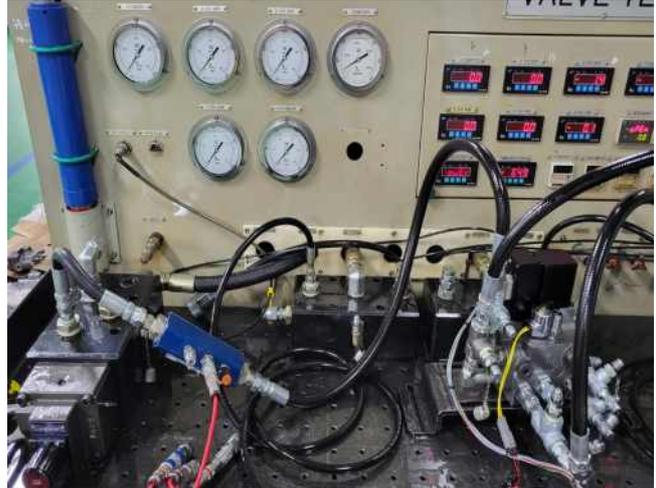
그림 73. 자동 조향 시스템 성능시험기 및 장착 사진
