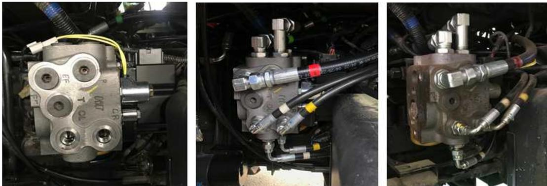
그림 100. 자동 조향 제어밸브 Proto 조립 모습
