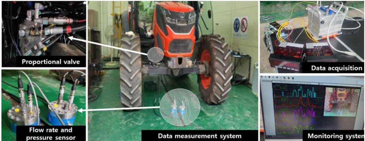
그림 165. 자동조향용 트랙터 유압시스템 동특성 분석을 위한 계측 시스템
