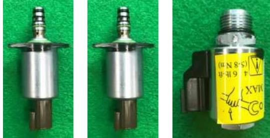
그림 25. 비례슬레노이드 2종 및 온오프슬레노이드
