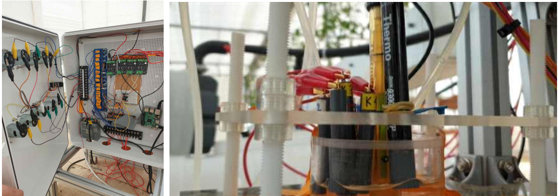
〈그림〉 (좌) 임베디드 기반 이온모니터링 시스템 시작기, (우) 이온센서 전극
