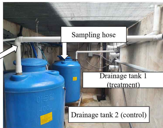
〈그림〉 ISE이용 이온 모니터링 및 양분 흡수 패턴 기반 양분 관리 시스템 실제 구성
