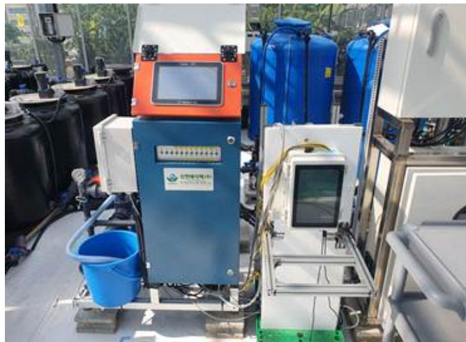
〈그림〉 신한에이텍 양액기 연동 양액 공급 제어 장치
