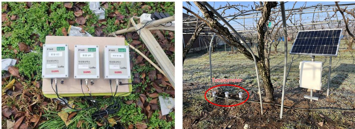
그림 2-14 무선 토양 센서(좌), 레퍼런스 센서-토양 수분센서 및 텐시오미터(우)
