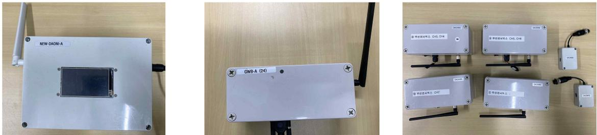
그림 2-5 모니터링 장치(좌), 게이트웨이(중간), 무선센서박스(우)
