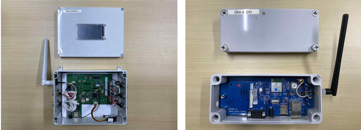
그림 2-7 모니터링 장치 시제품(좌), 게이트웨이 시제품(우)
