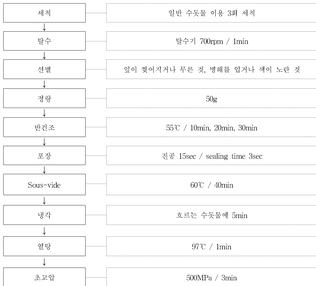
Figure 16. 반건조 공정 효과 검증을 위한 처리 공정도
