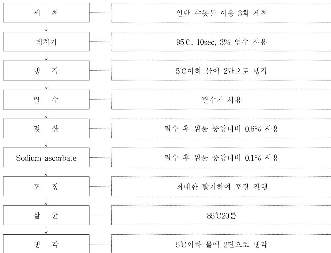
Figure 85 산도조절제와 산화방지제를 사용한 나물의 가공
