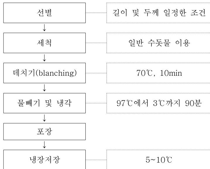
Figure 25. Cook-chill 처리에 의한 가공공정
