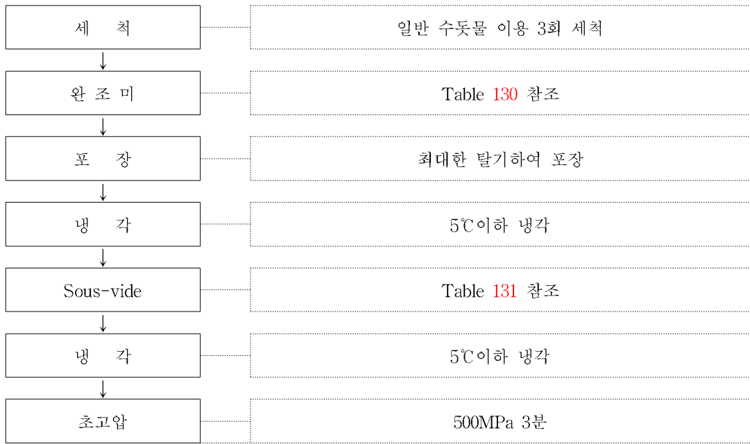
Figure 83 초고압을 활용한 나물 가공의 최종 공정도
