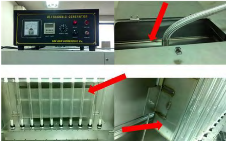
그림 10. Batch식 UV-광촉매 반응기에 삽입된 초음파 조사장치 (빨간 화살표)
