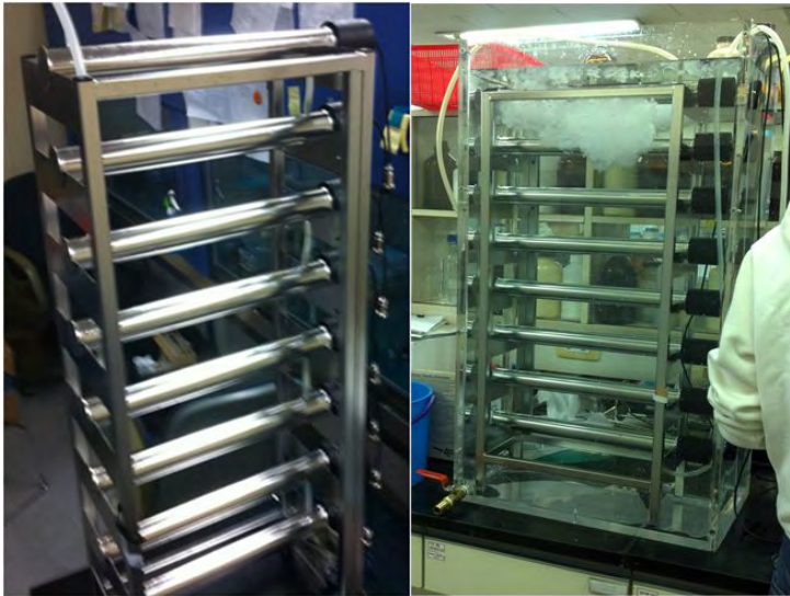
그림 9. 냉각 시스템 적용 전(좌), 후(우)의 연속식 광촉매 처리장치
