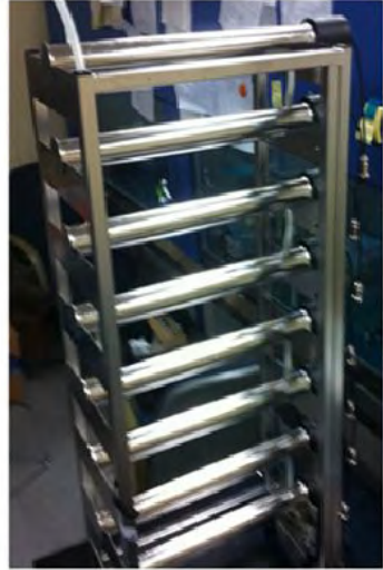
그림 8. 연속식 UV-광촉매 반응기의 모식도
