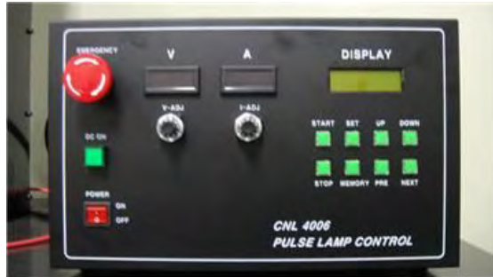
그림 187. 소형화된 고강도광펄스 시스템의 전원 장치
