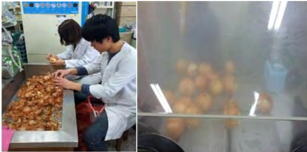
그림 219. 양파 시료 전처리 및 아염소산수를 이용한 항균 실험
