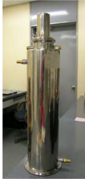
그림 2. 살균용 lab-scale UV-광촉매 반응기의 모식도
