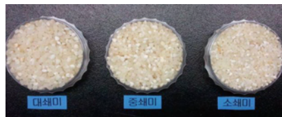
그림 1. Sieve에 따른 찌라기의 분리(대쉐미, 중쉐미, 소쉐미).
