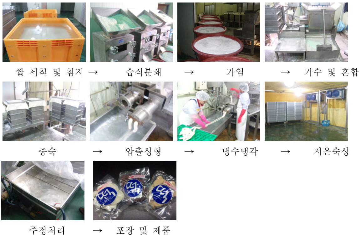
그림 5. 부산물을 활용한 기능성 떡국의 제조공정.
