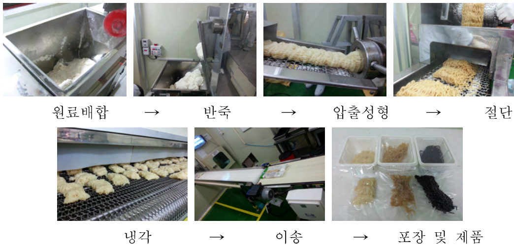
그림 1. 부산물을 활용한 기능성 쌀면의 제조과정.
