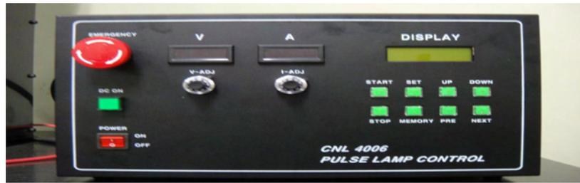
그림 11. 고강도 광펄스 시스템의 전원 장치
