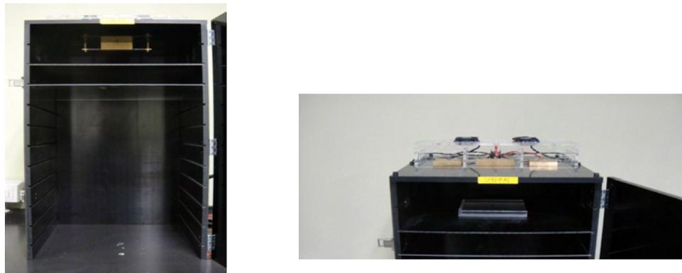
그림 12. 고강도 광펄스 처리를 위한 회분식 처리 장치
