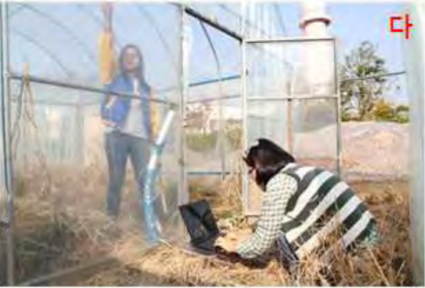
사진 1-35. 광선택적 차광제(GreenShade)살포와 광과장 측정 장면. 가, 나: 차광제 도포광경, 다: 미니온실 내부 광과장 측정, 라: 미니온실 외부 광과장 측정.
