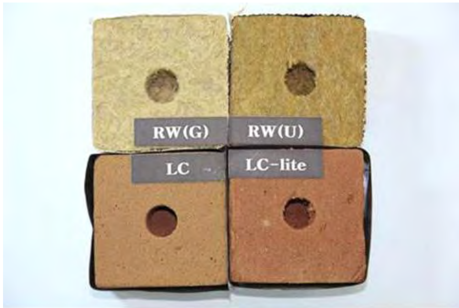
사진 1-14. 파프리카 'Fascinato' 품종의 육묘실험에 사용된 4종류의 육묘용 큐브형 배지. RW(G); Grodan rockwool, RW(U); UR rockwool, LC; phenolic foam LC, LC-lite; phenolic foam LC-lite.
