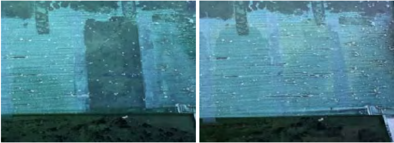
사진 3-5. GreenShade 대상 박리 test 전, 후 (좌측부터 ShadeCleaner, 보완 샘플 A, 보완 샘플 B).
