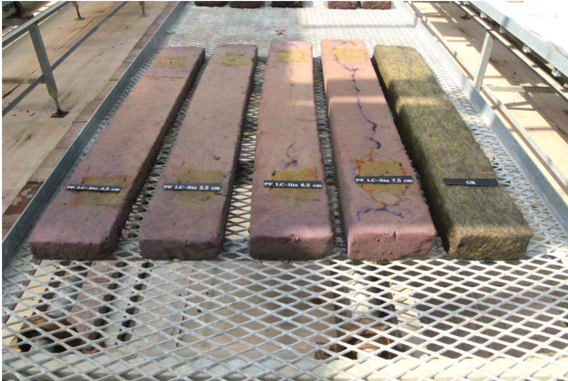
사진 1-62. 높이별 신개발 슬래브형 phenolic foam배지와 암면(좌측부터 슬래브 높이가 각각 4.5, 5.5, 6.5, 7.5cm phenolic foam배지와 7.5cm 암면배지).
