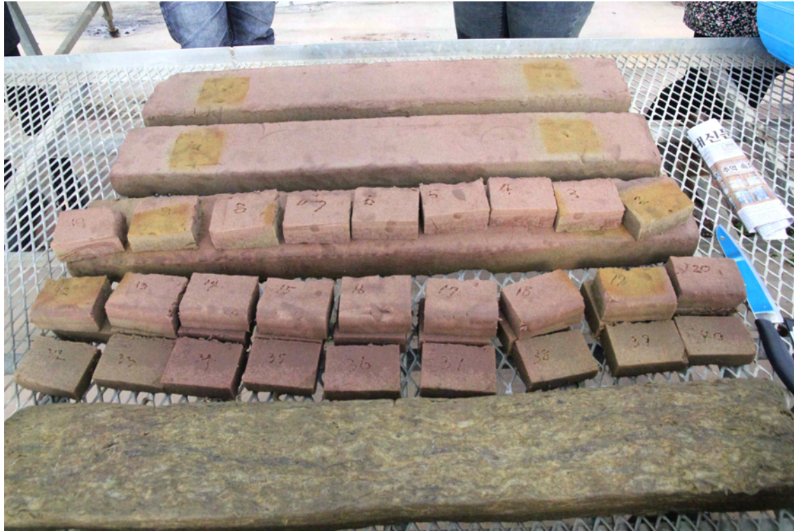
사진 1-61. 배지의 위치별 pH와 EC를 측정하기 위해 40 등분 한 모습.
