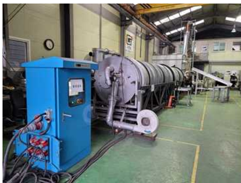
그림 22. 모듈형 고열 가축사체 멸균소각기 세부도면(조감도) 및 실제사진
