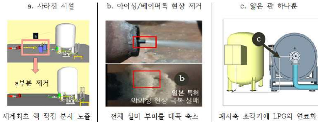
그림 13. 액분사 연료 시스템이 적용된 폐가축 소각기 도식화
