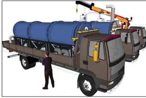
그림 20. 이동형 모듈형 소각기 모식도
