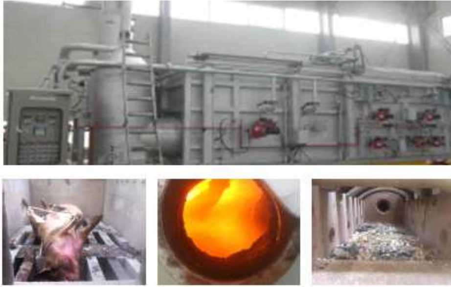
그림 6. 폐사가축 이동식 소각시설 및 시운전
