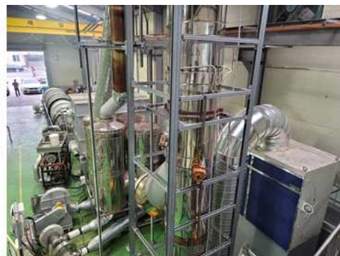
그림 22. 모듈형 고열 가축사체 멸균소각기 세부도면(조감도) 및 실제사진
