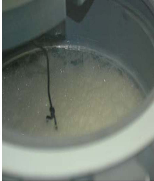
그림 46. 오존기포에 의한 부상공정의 스킴 형태(기포가 큼)
