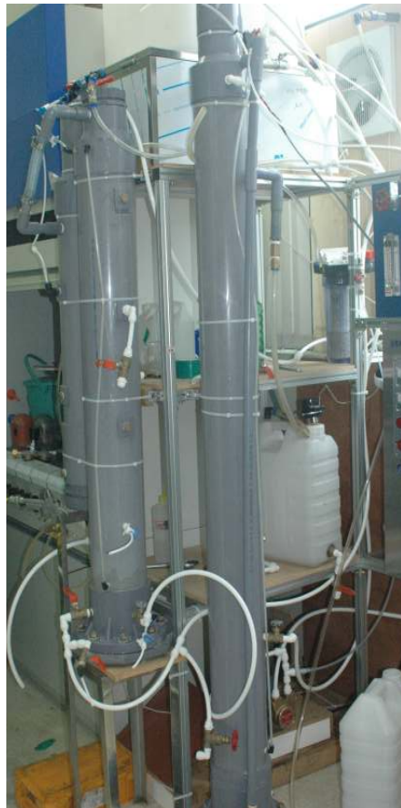
그림 22. 소형 Pilot 고도산화공정 시스템
