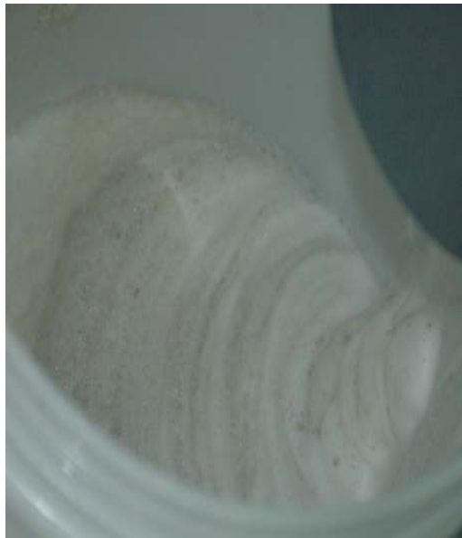
그림 47. 오존 미세기포에 의한 스킴 형태(기포 크기가 작고 점성이 있음)
