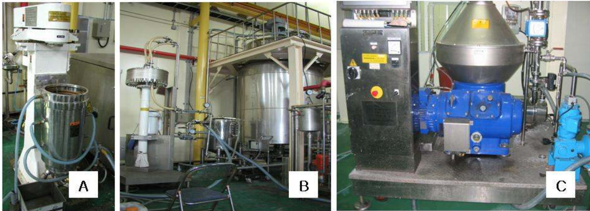
그림 40. 여액 분리를 위한 후공정 기기(A; Tubular Centrifuge, B; Pall. sep., C; Alfa laval)
