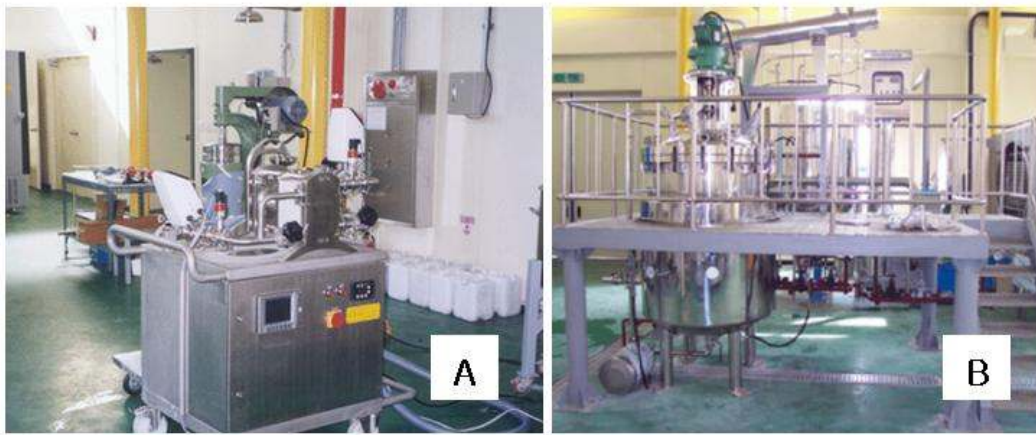
그림 42. 농축용 후공정 기기(A; 한외여과시스템, B; 감압농축시스템)
