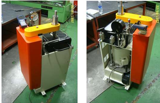
그림 3-1-4. 실험실 규모(5 L)의 Autoclave(아임계 추출 또는 superheated water extraction system).
